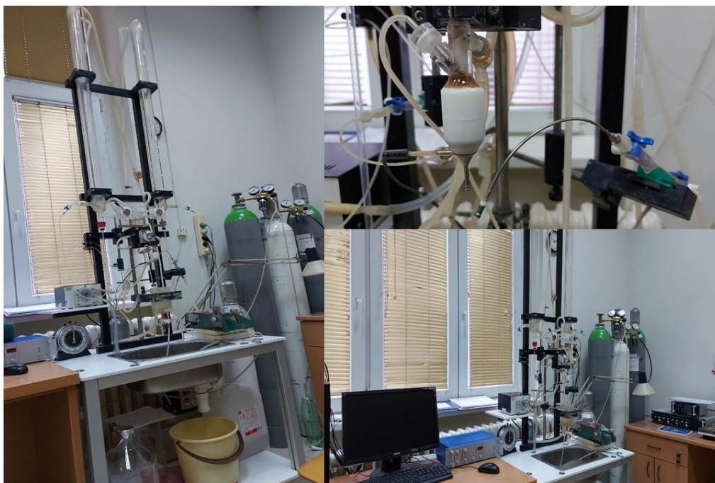
Слика 3.1. Лангендорфов апарат за перфузију изолованог срца сисара (лијево) и канила за качење изолованог срца сисара и сензор који се поставља у лијеву комору (десно).
