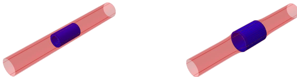
(в) стент уметнут у артерију при T < T_g (г) обновљен облик стента загревањем Слика 7.23: Приказ фаза симулације убацивања стента у артерију
