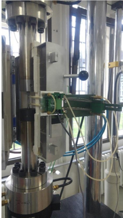
Слика 4.8.: Уграђен екстензометар на комори: а) пре загревања и б) за време загревања са укљученим системом воденог хлађења
