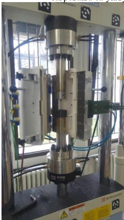
Слика 4.9: Додатна опрема за испитивање на повишеним температурама: а) Комора за загревање узорака и б) контролер коморе
