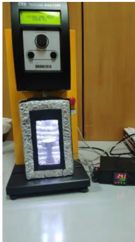
Слика 4.10: Комора за испитивање полимерних материјала на повишеним температурама адаптирана на постојећи мерни систем Brookfield - Центар за трибологију, Факултет инжењерских наука, Универзитет у Крагујевцу
