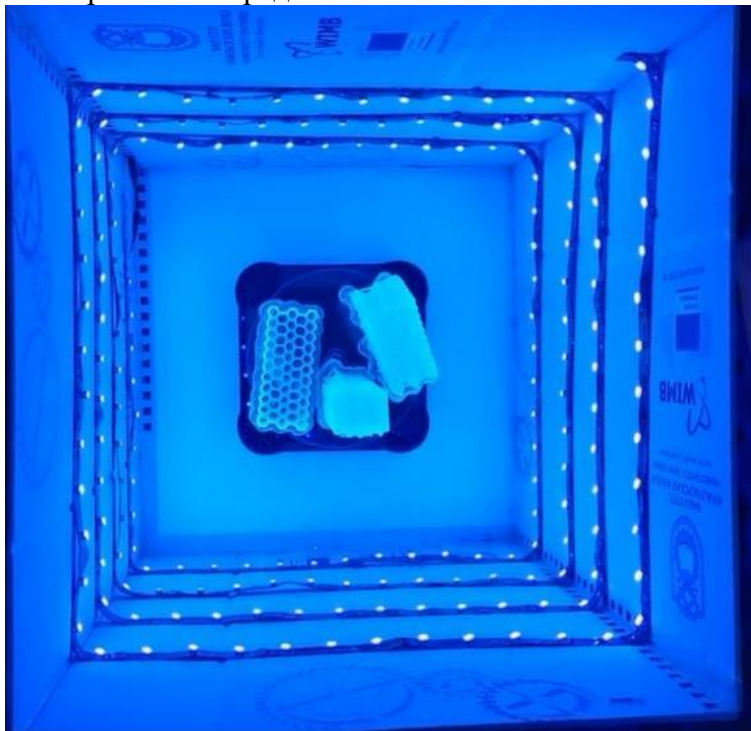
Слика 4.19: Трегирање узорака фотополимера у UV комори
