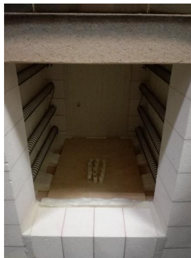
(b) Прогревање израђених узорка у пећи
