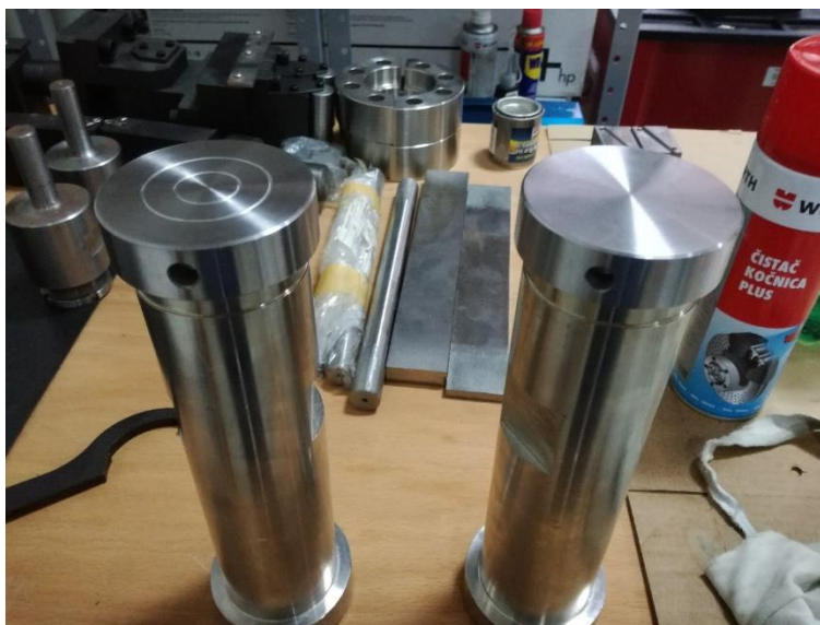
Слика 4.11: Додатни прихватни алати направљени за испитивање у комори високих температура на мерном систему Shimadzu, Центар за динамичка испитивања и инжењерски софтвер, Факултет инжењерских наука, Универзитет у Крагујевцу
