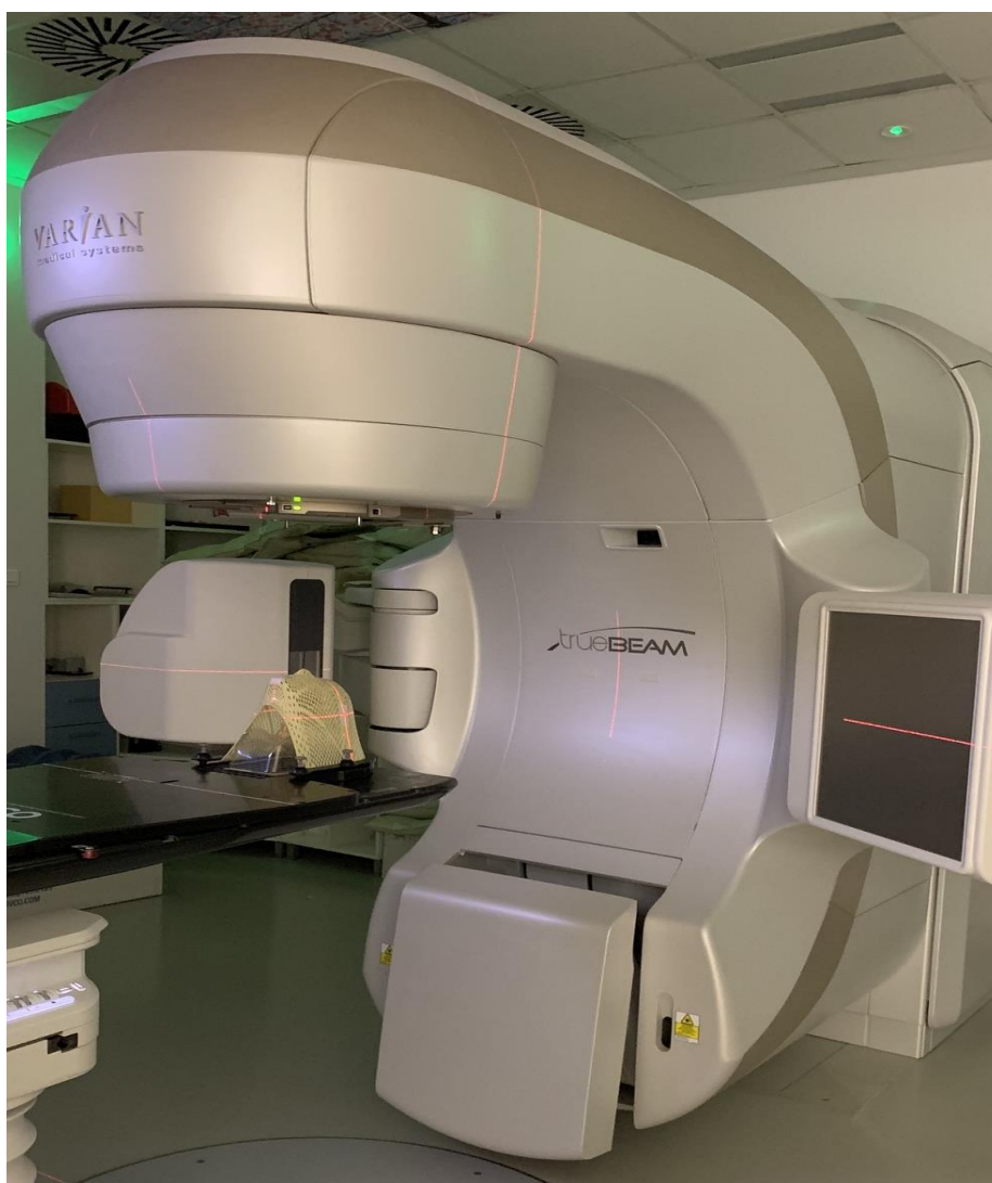
Slika 12. Okruženje radioterapijskog aparata, linearanog akceleratora, sa laserskim sistemom za precizno pozicioniranje pacijenta (materijal Instituta za onkologiju i radiologiju Srbije)
