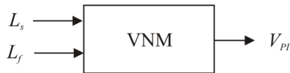
Slika 4.10 Neuronski model za određivanje zavisnosti napona aktivacije od dimenzija prekidača [23]
