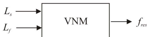
Slika 4.8 Veštačka neuronska mreža za modelovanje RF MEMS prekidača
