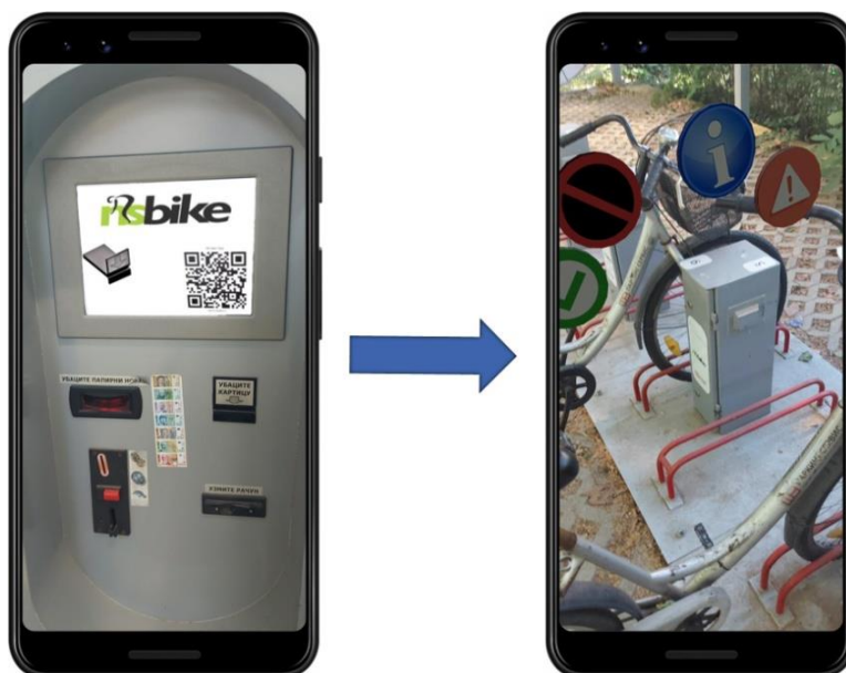
Slika 45. Prošireno praćenje pri čemu objekti ostaju vidljivi iako marker nije više vidljiv
