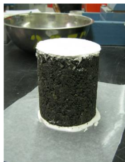
Слика 9.6. – Узорак са слојевима гипса на горњој и доњој површини
