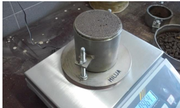
Фотографија 11. – Стабилизацијски узорак након скидања наставка са калупа и поравнања његове горње површине
