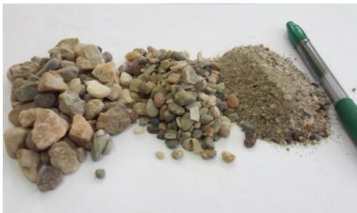
Слика 2.7. – Природни агрегат шљунка (G – Gravel), фракције 8/16, 4/8, 0/4mm
