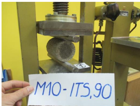
Фотографија 16. – Стабилизацијски узорак у преси, припремљен за тзв. бразилски опит цијепања (одређивање ITS-a)
