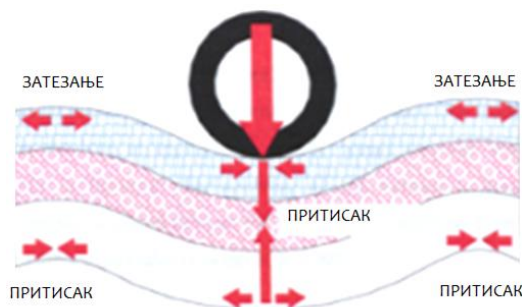
Слика 4.1. – Приказ напона и деформација у слојевима коловозне конструкције [3]
