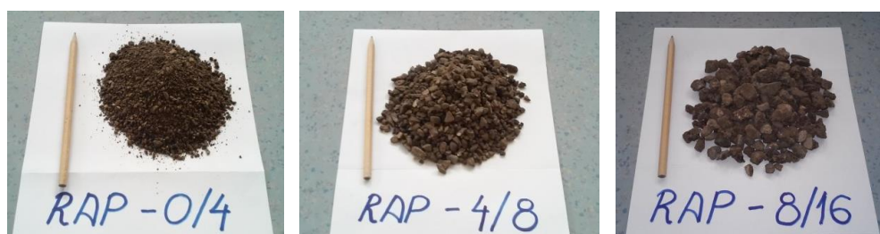
Слика 10.2. – Фракције (3) рециклираног асфалтног агрегата (RAP-а) коришћеног у истраживању (0/4, 4/8 и 8/16mm)
