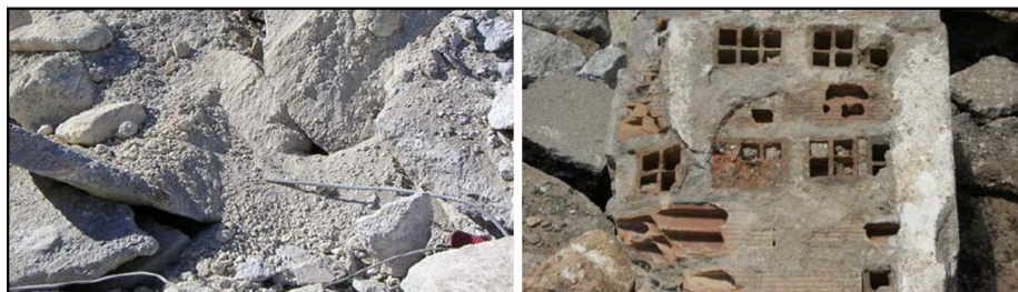
Слика 9.10. – Отпадни бетон и зидарска опека, коришћени као дробљени рециклирани агрегат (MRA1 и MRA2) у стабилизацијама
