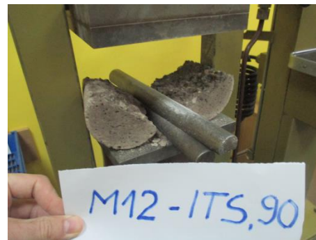
Фотографија 17. – Лом стабилизацијског узорка након опита цијепањем
