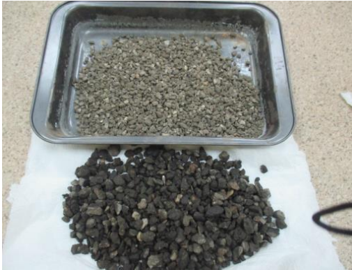
Фотографија 1. – Разлика у боји осушеног (фракција 4/8mm) и водом засићеног (фракција 8/16mm) RAP-а
