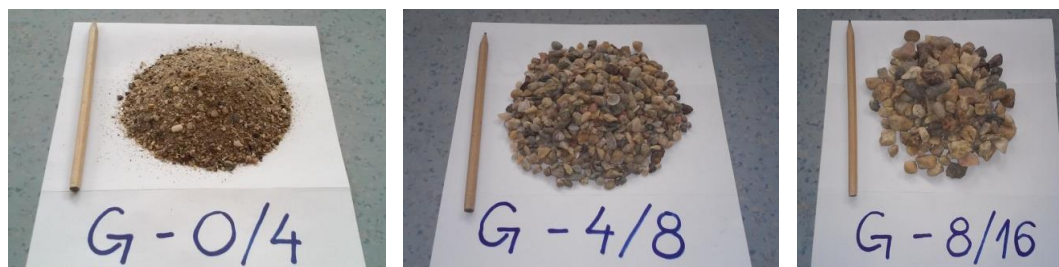
Слика 10.1. – Фракције (3) природног агрегата шљунка – G (0/4, 4/8 и 8/16mm)
