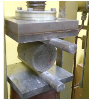
Слика 6.11. – Лабораторијско испитивање индиректне затезне чврстоће (ITS)
