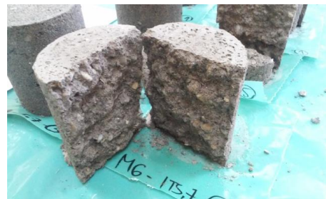
Фотографија 19. – Правилан лом узорка, настао при одређивању индиректне затезне чврстоће (ITS)
