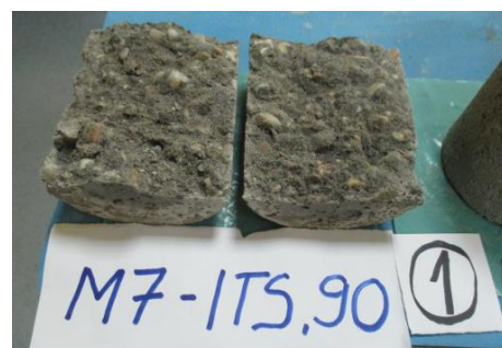
Фотографија 21. – Подужни пресјек стабилизацијског узорка са природним агрегатом шљунком, након опита цијепања
