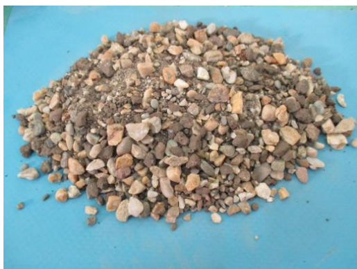
Фотографија 5. – Мјешавина природног агрегата шљунка и рециклираног асфалтног агрегата у односу 70:30
