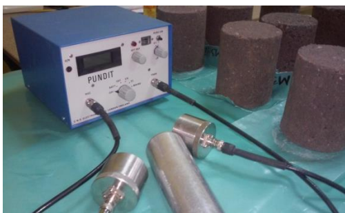
Слика 6.12. – Инструмент PUNDIT за испитивање брзине и времена проласка ултразвука
