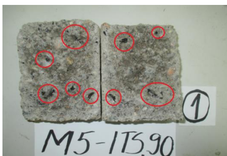
Фотографија 20. – Видљива зрна рециклираног асфалтног агрегата на уздужном пресеку цилиндричног узорка (након испитивања ITS-a)
