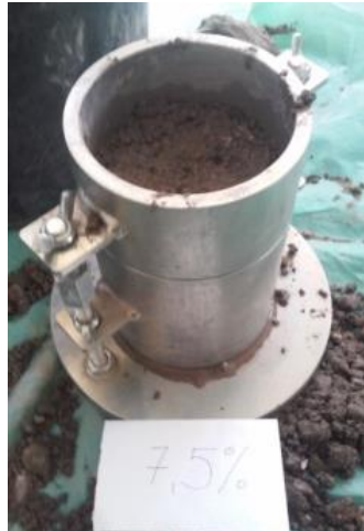
Фотографија 8. – Сегрегација воде на дну цилиндричног калупа након поступка збијања
