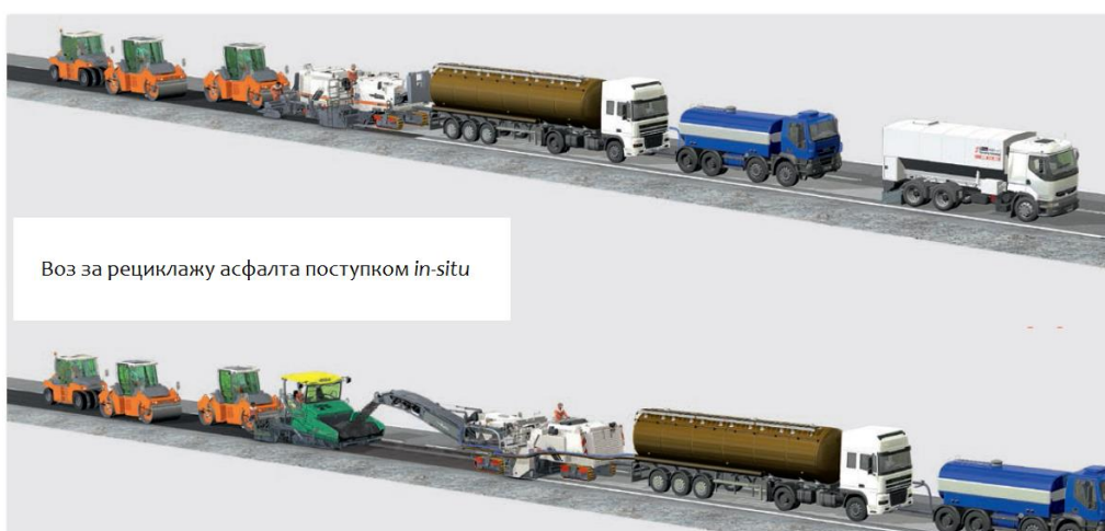
Слика 7.8. – Различит приказ технологија стругања старог асфалта и справљања нове цемента стабилизоване мјешавине [93]
