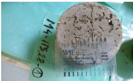
Фотографија 18. – Пукотина настала након лома узорка, при одређивању индиректне затезне чврстоће (ITS)
