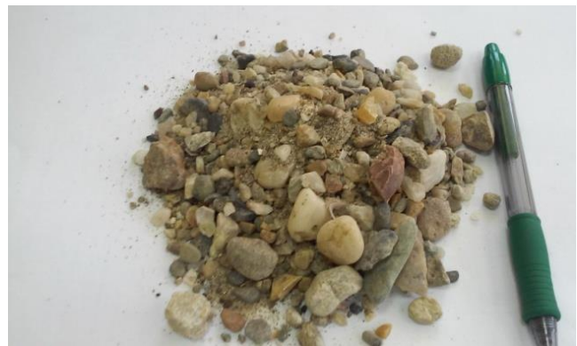
Фотографија 4. – Мјешавина природног агрегата шљунка (0/16mm)
