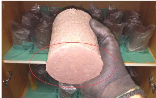
Слика 6.14. – Издвајање цементне пасте (усљед слијегања) на доњем површинском слоју очврслог стабилизацијског узорка
