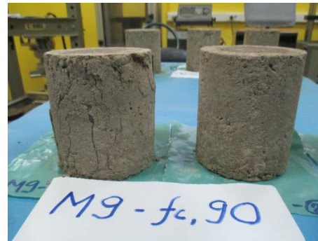
Фотографија 15. – Правилан лом узорка (лијево) после испитивања чврстоће при притиску ( f_c ) у односу на узорак прије испитивања (десно)
