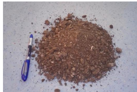
Слика 2.8. – Рециклирани асфалт (RAP – Recycled Asphalt Pavement), гранулација 0/16mm
