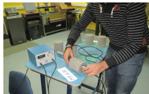
Слика 6.13. – Мјерење времена проласка ултразвучног таласа кроз цилиндрични узорак
