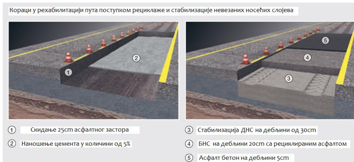
Слика 7.13. – Рециклажа неvezаних слојева коловозне конструкције у циљу повећања носивости [31]
