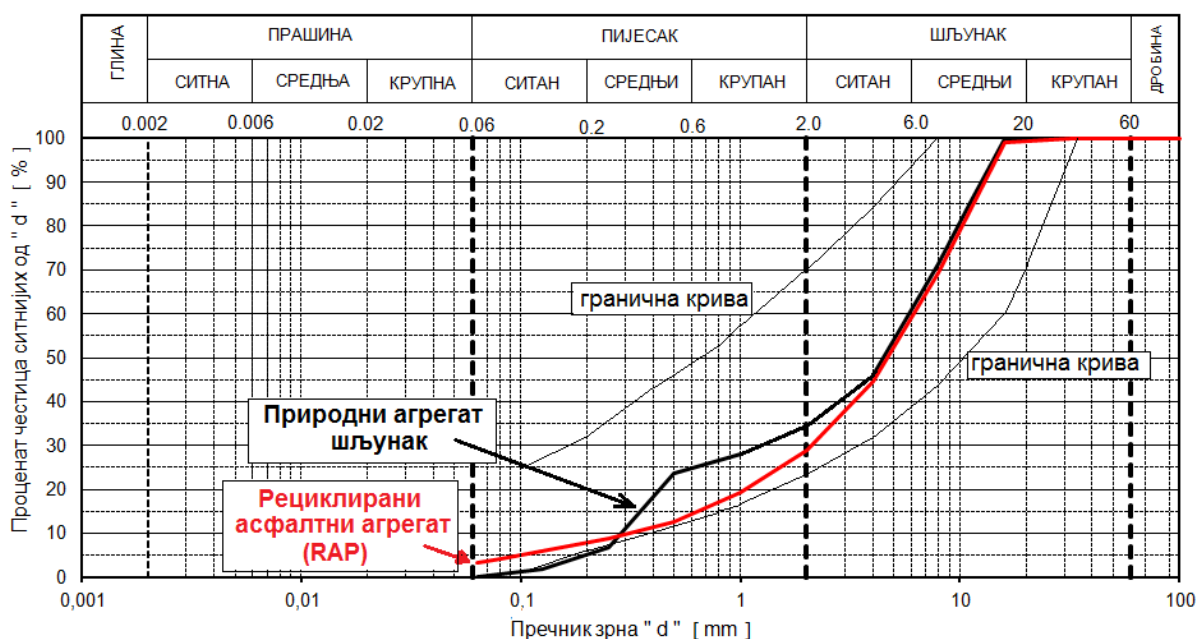
Графикон 10.3. – Упоредни приказ гранулометријских састава двије врсте агрегата и граничне криве (за стабилизацију агрегата гранулације 0/32mm) [22]
