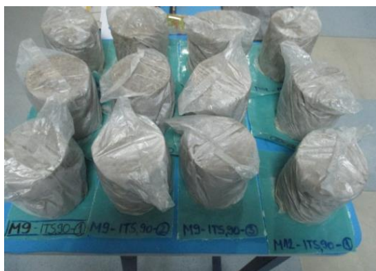
Фотографија 12. – Заштита стабилизацијских узорка PVC фолијама ради одржавања константне влажности
