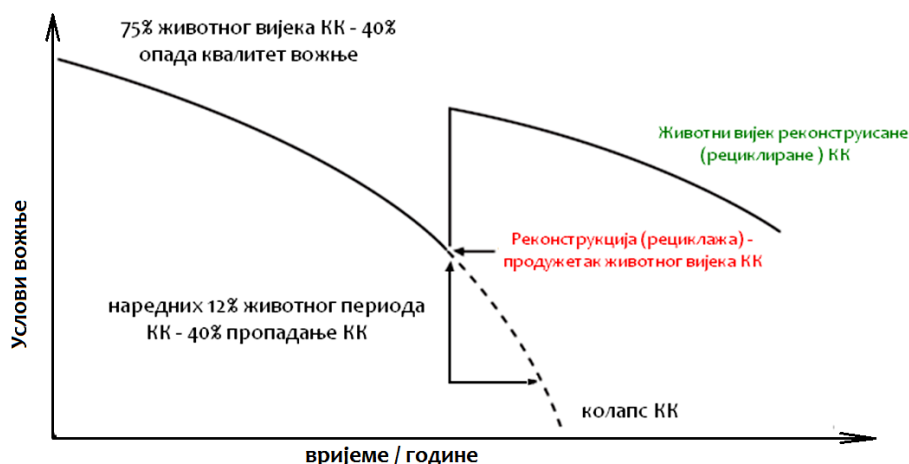
Графикон 3.3. – Пад квалитета возње у функцији времена и повећање истог након реконструкције коловозне конструкције 5 , поступком рециклаже [4]
