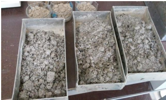
Фотографија 10. – Стабилизацијска мјешавина након поступка сушења и одређивања суве запреминске масе
