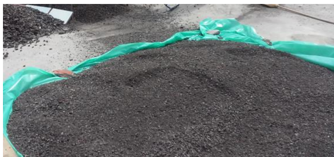
Слика 7.2. – Рециклирани асфалт са локације: Иришки венац (Државни пут 1Б реда (број 21), Нови Сад-Рума), који је коришћен у овом истраживању
