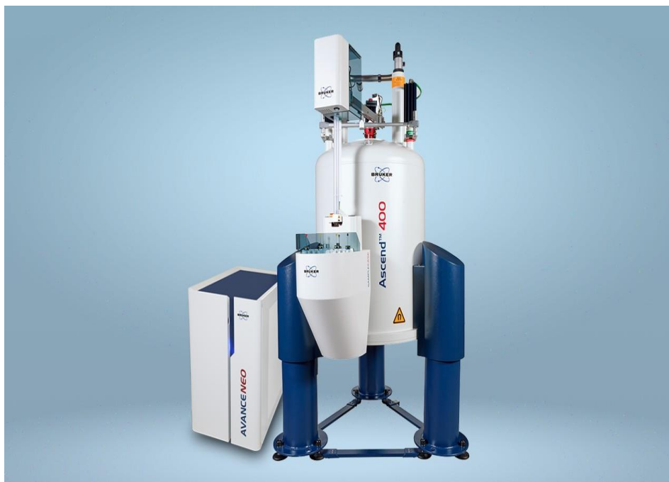
Slika 3.7. Bruker Avance III 400 MHz spektrometa
