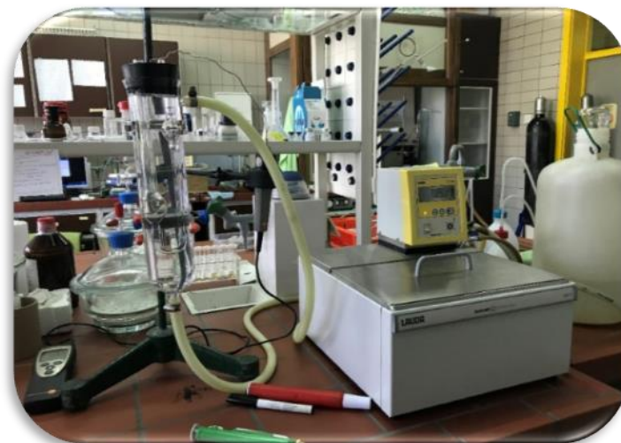
Slika 3.4. Aparatura za merenje viskoznosti sa Ostvald-ovim viskozimetrom
