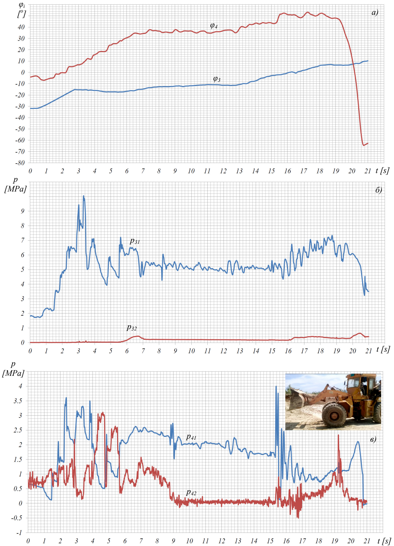
Сл. ПЗ.6 Мерење величине при шестом манипулационом задатку: а) углови \varphi_3 , \varphi_4 положаја стреле и кашике, б) притисци p_{31} и p_{32} у радним водовима хидроцилиндара стреле, в) притисци p_{41} и p_{42} у радним водовима хидроцилиндара кашике
