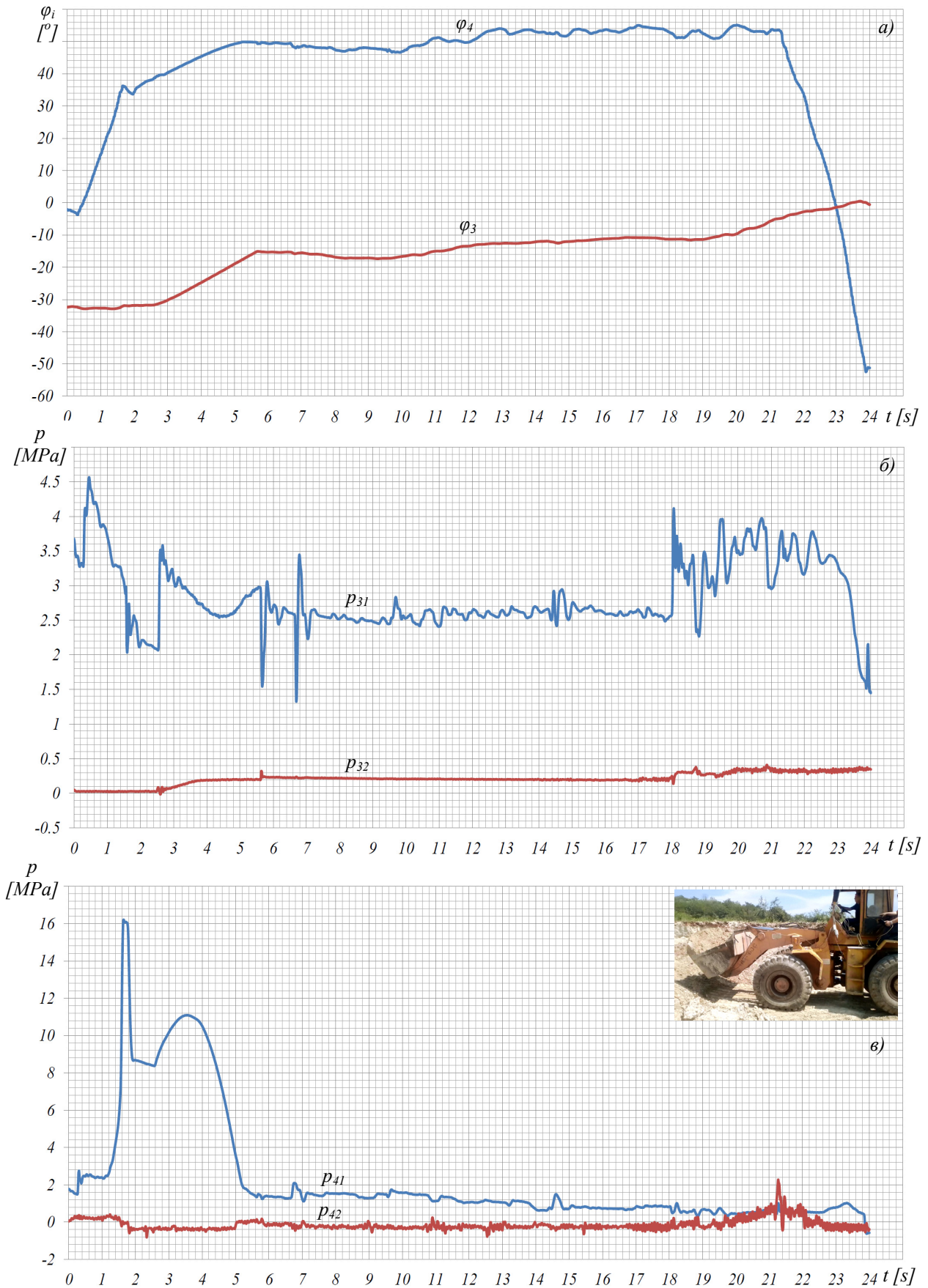
Сл. ПЗ.3 Мерене величине при првом манипулационом задатку: а) углови \varphi_3 , \varphi_4 положаја стреле и кашике, б) притисци p_{31} и p_{32} у радним водовима хидроцилиндара стреле, в) притисци p_{41} и p_{42} у радним водовима хидроцилиндара кашике
