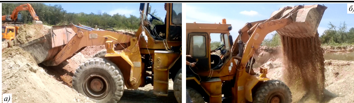
Сл. ПЗ.1 Операције манипулационог задатка при испитивању утоваривача: а) захватање, б) истовар материјала
