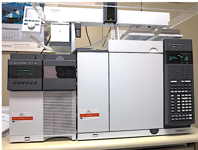
Slika 30. Gasni hromatograf sa masenim analizatorom Agilent 7890B/5977A MSD korišćen za analizu novootkrivenih jedinjenja
