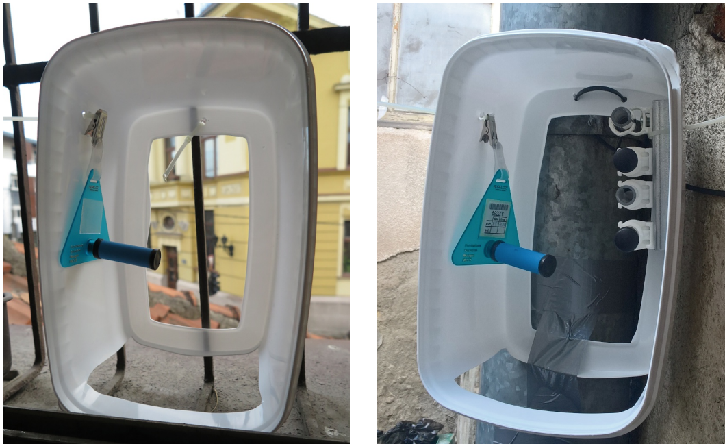
Сл. 3.16 Пасивни узоркивачи постављени у заштитне конструкције споља
