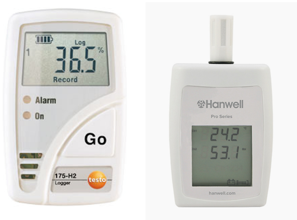
Сл. 3.11 Уређаји за континуално праћење релативне влажности и температуре: Testo 175-H2 (лево) и Hanwell ML 4106
