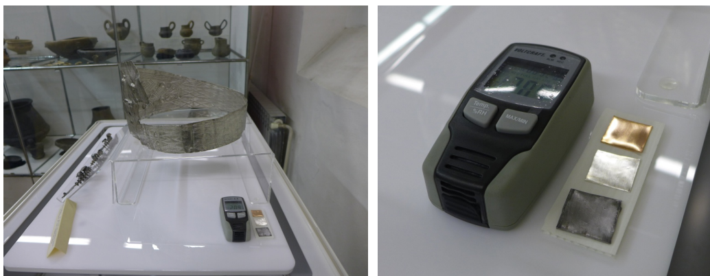
Сл. 3.12 Даталогер који се користи за континуално мерење релативне влажности и температуре у Завичајном музеју у Јагодини: Voltcraft DL-140TH
