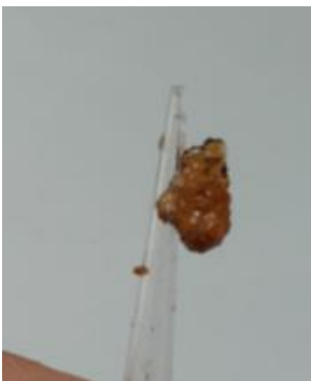
Slika 68: Uspešno formiran hidrogel 5 mol% dopamin-karboksimetilceluloze u prisustvu natrijum-perjodata u baznoj sredini
