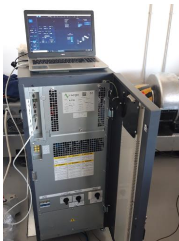
Слика 2.32 Cinergia B2C-15 коришћен као програмабилни извор константне струје
