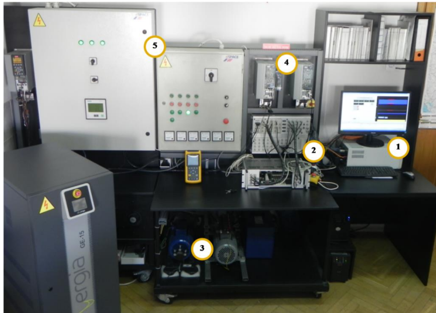
Слика 4.13 Експериментална поставка за верификацију потенцијала енергије рекулериције (1 – dSpace контролна картица, 2 – I/O интерфејс, 3 – механички спрегнуте асинхроне машине, 4 – фреквенцијски претварачи у back-to-back топологији и 5 – склопна и заштитна опрема)
