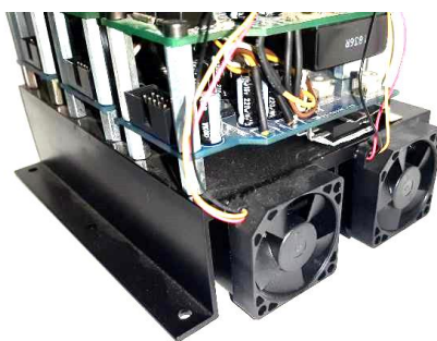
Слика 3.89 Хладњак и вентилатори за форсирано хлађење са монтираним прекидачким компонентама
