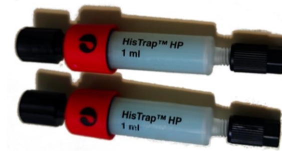
Слика 4.3. Колоне за металоафинитетну хроматографију напуњене никал-сулфатом.
