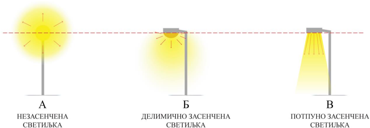
Прилог 14. Најчешће конструкције уличних светиљки у свету (Извор: аутор према Mikuž, Zwitter, 2005)
