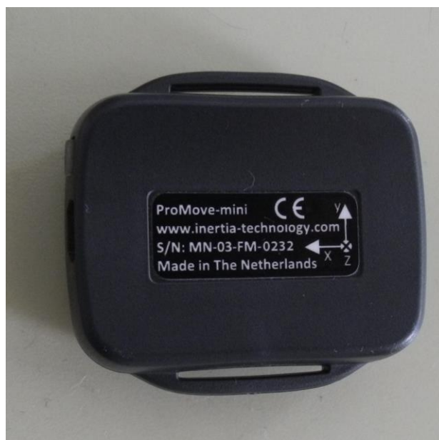
Слика 8. Инерцијални сензор и његова оријентација (x,y,z осе). (Слика преузета из личне архиве)
