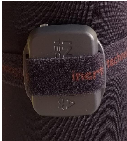
Слика 7. Сензор ProMove-Mini Inertia Technology (Холандија) (Слика преузета из личне архиве)
