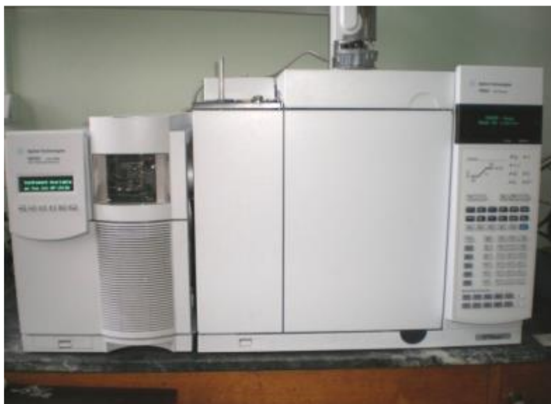
Slika 24. Gasni hromatograf sa masenim spektrometrom (Stojanović, 2017).
