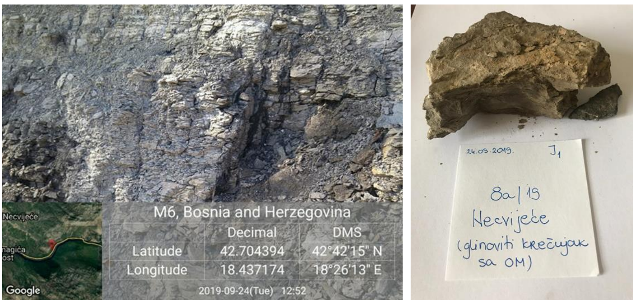
Slika 33. Uzorkovani izdanak laporca sa organskom materijom i tragovima bitumija na lokalitetu Necvijeće (levo) i uzorak glinovitog krečnjaka sa organskom materijom 8a-Necvijeće (desno).
