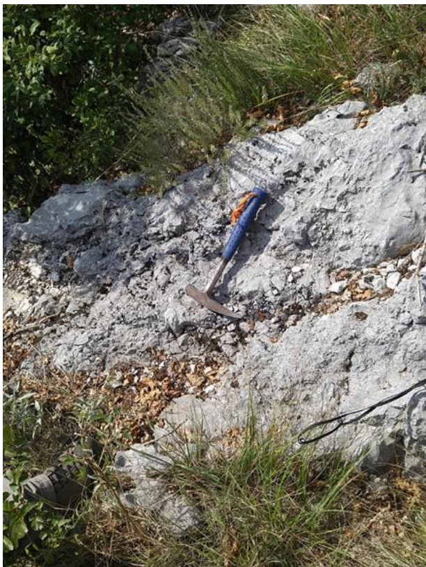
Slika 34. Uzorkovani izdanak svetlo-sivih grudvastih krečnjana sa asfaltnom naftom (bitumijom) na lokalitetu Mišljen.
