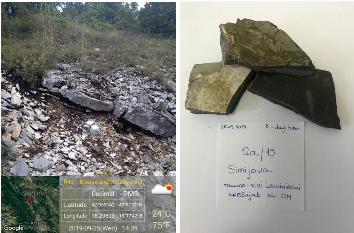
Slika 41. Uzorkovani izdanak na loklitetu Simijova (levo) i uzorak tamno-sivog laminiranog krečnjaka sa organskom materijom 12a-Simijova (desno).
