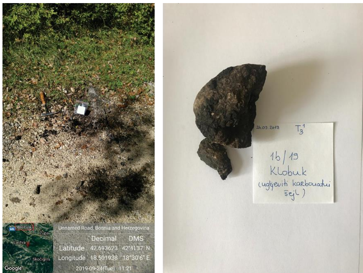
Slika 30. Uzorkovani izdanak na lokalitetu Klobuk (levo) i uzorka ugljevitog karbonatnog šejla 1b-Klobuk (desno).
