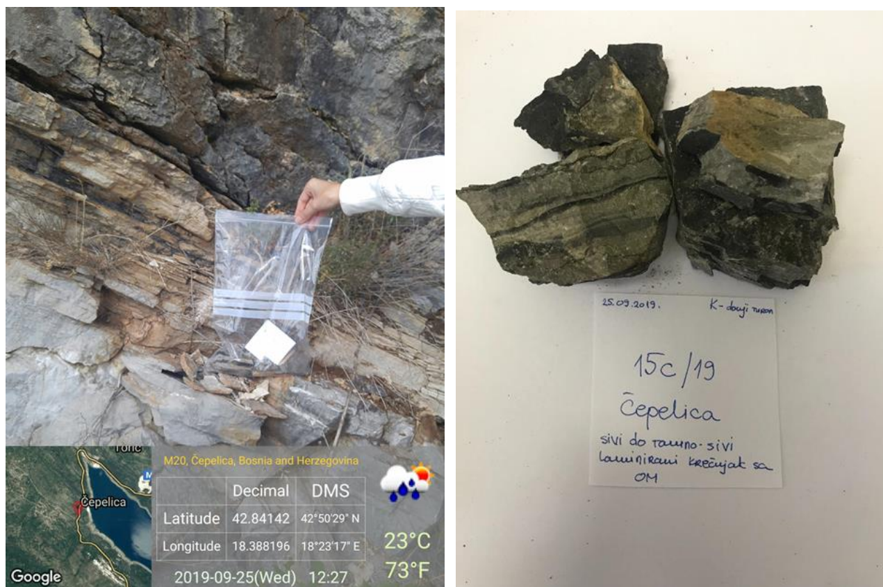
Slika 36. Uzorkovani zdanak lokalitetu Čepelica (levo) i uzorak tamno-sivog laminiranog krečnjaka sa organskom materijom 15c-Čepelica (desno).
