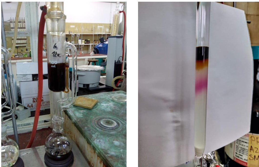
Slika 98. Ekstrakcija (levo, zbog velike količine bitumena balon je više puta menjan, a ekstrakti objedinjeni) i eluiranje aromatične frakcije (desno) uzorka 26-Mišljen-2.
