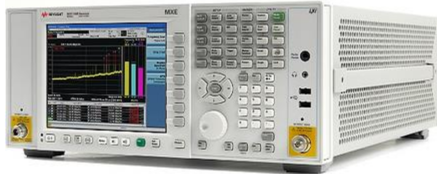
Slika 3.6 EMI prijemnik Keysight N9038 korišćen u praktičnim laboratorijskim ispitivanjima
