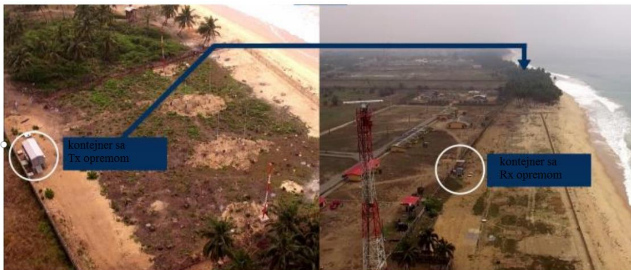
Slika 4.12 Kratkotalasni radar u realnosti, sa međusobnim rastojanjem predajne i prijemne opreme [46]
