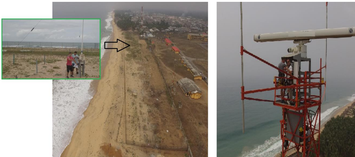
Slika 4.3 Razlika između antena kod kratkotalasnog radara (levo, uveličana jedna od 20 antena) i mikrotalasnog radara (desno, samo jedna antena se koristi i za predaju i za prijem)
