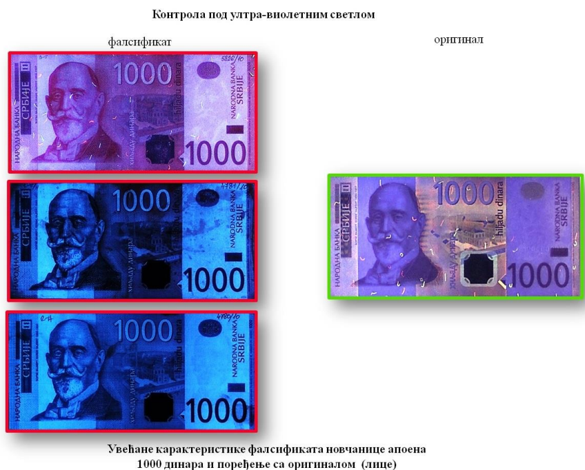
Сл.3. 53 Поређење фалсификата и оригинала новчанице у апоену од 1000 динара под УВ светлом
