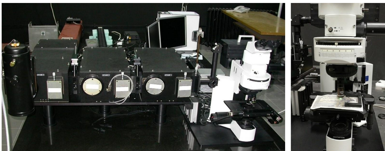
Сл.4. 6 Троструки спектрометар TriVista TR557 са микроскопом (лево) и микроскоп са узорком – новчаницом (десно), Институт за физику, Лабораторија за чврсто стање
