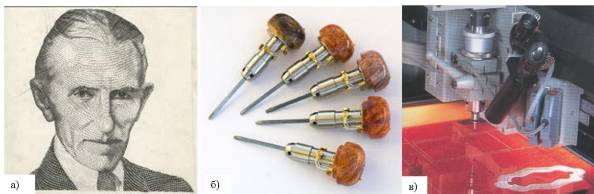
Сл. 3.1 а) Израда увећаног припремног цртежа за гравирање; б) Алати за ручно гравирање, в) Гијоширање дијамантском иглом
