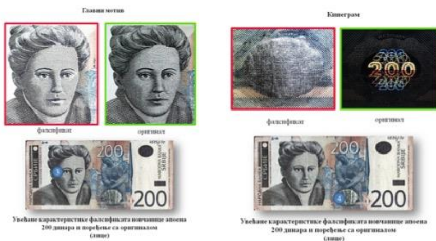
Сл.3. 35 Поређење сигурносних елемената – главног мотива и кинеграма на фалсификату и оригиналу новчанице у апоену од 200 динара
