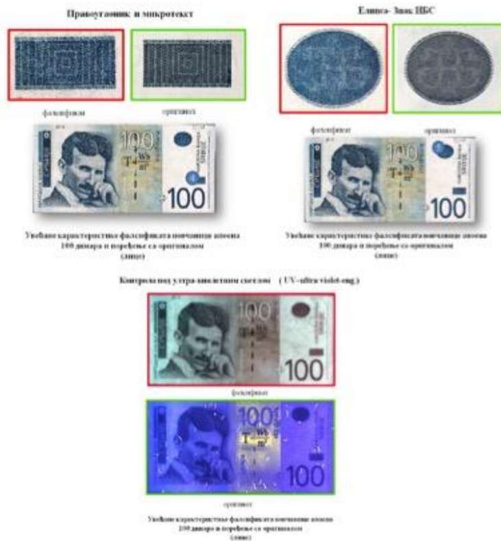
Сл.3. 28 Поређење сигурносних елемената – кин ефекта у правоугаонику, елипсе знака НБС и контрола под УВ светлом на фалсификату и оригиналу новчанице у апоену од 100 динара
