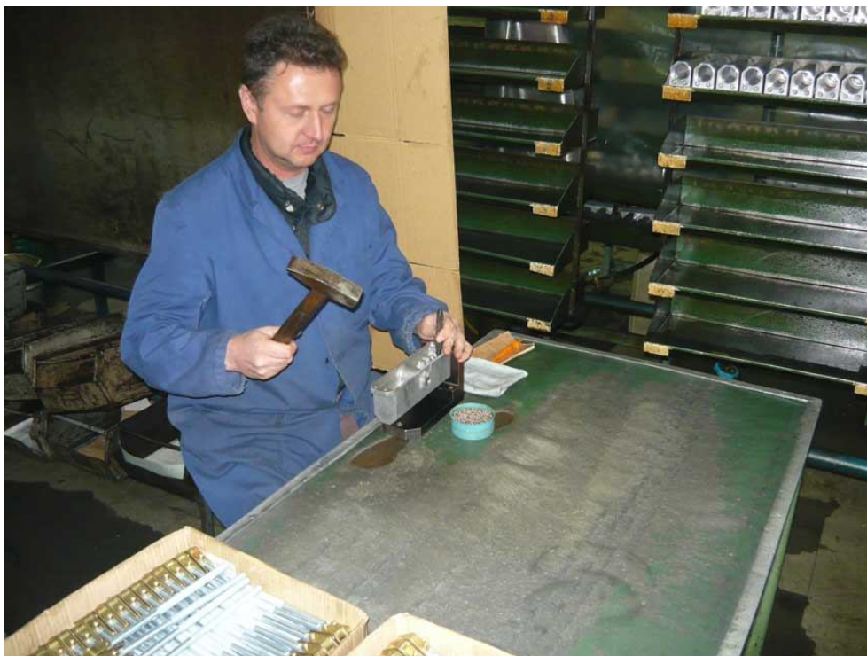
Слика 23 – Набијање челичне куглице, Циклус 2, Узорак 3, Београд
