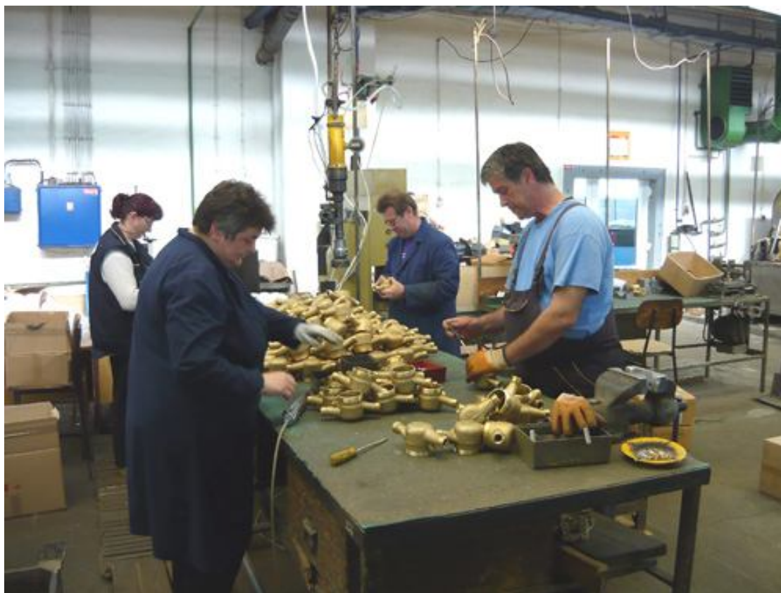
Слика 13 – Циклус 4 – Убацивање механизма “мокрих” водомера у кућишта, Узорак 1, ИНСА, Земун.
