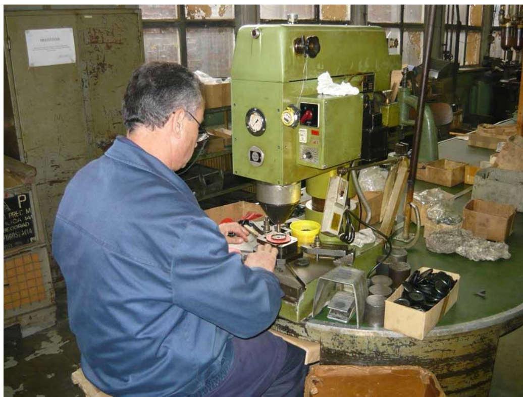
Слика 21 – Монтажа мембране, Циклус 1, Узорак 3, Београд
