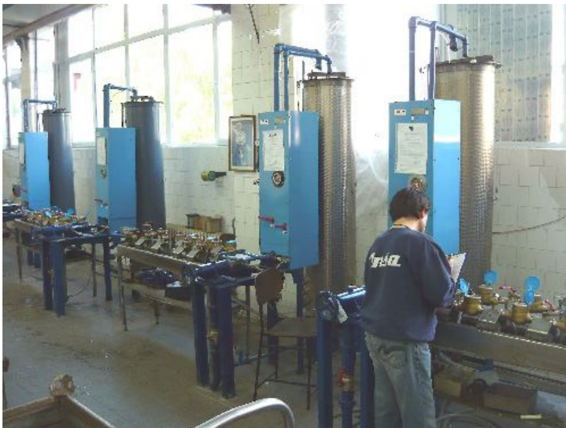
Слика 15 – Циклус 5 - Баждарење водомера, Узорак 1, ИИНСА, Земун.
