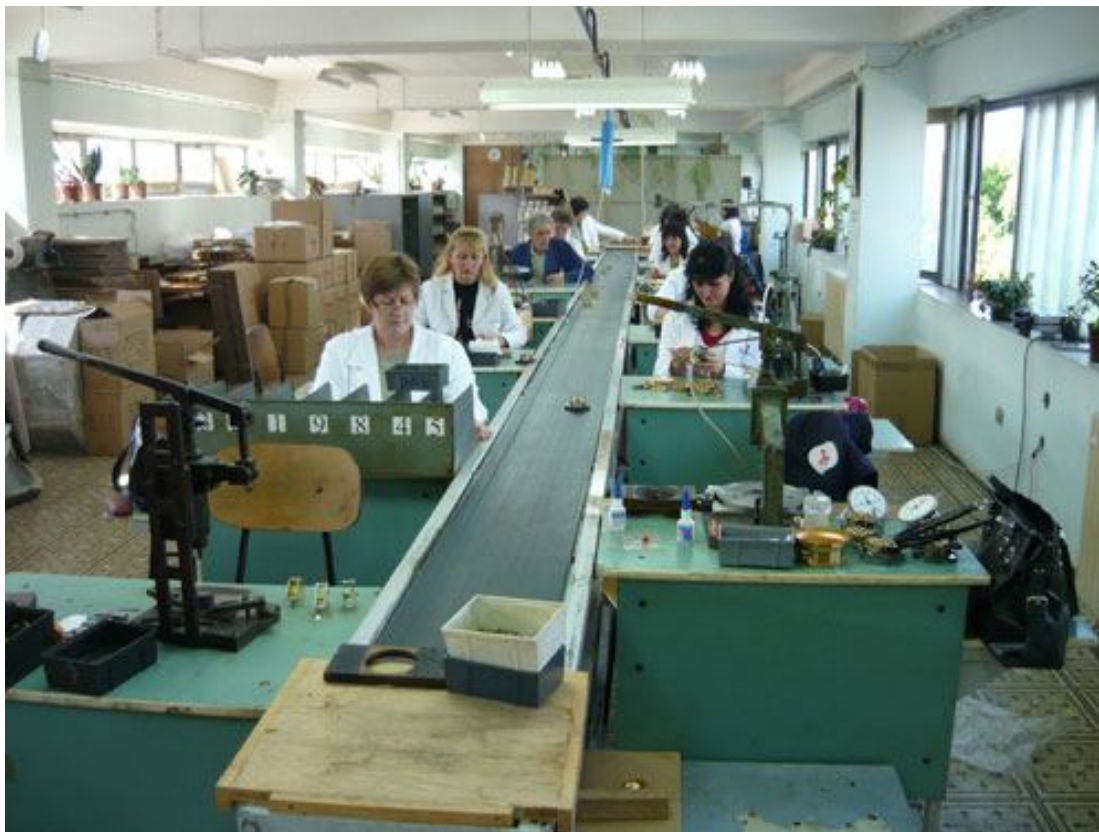
Слика 9 – Циклус 1 и 2 – Монтажа механизма код шах сатова и Убацивање механизма код шах сатова за Узорак 1, ИНСА, Земун.
