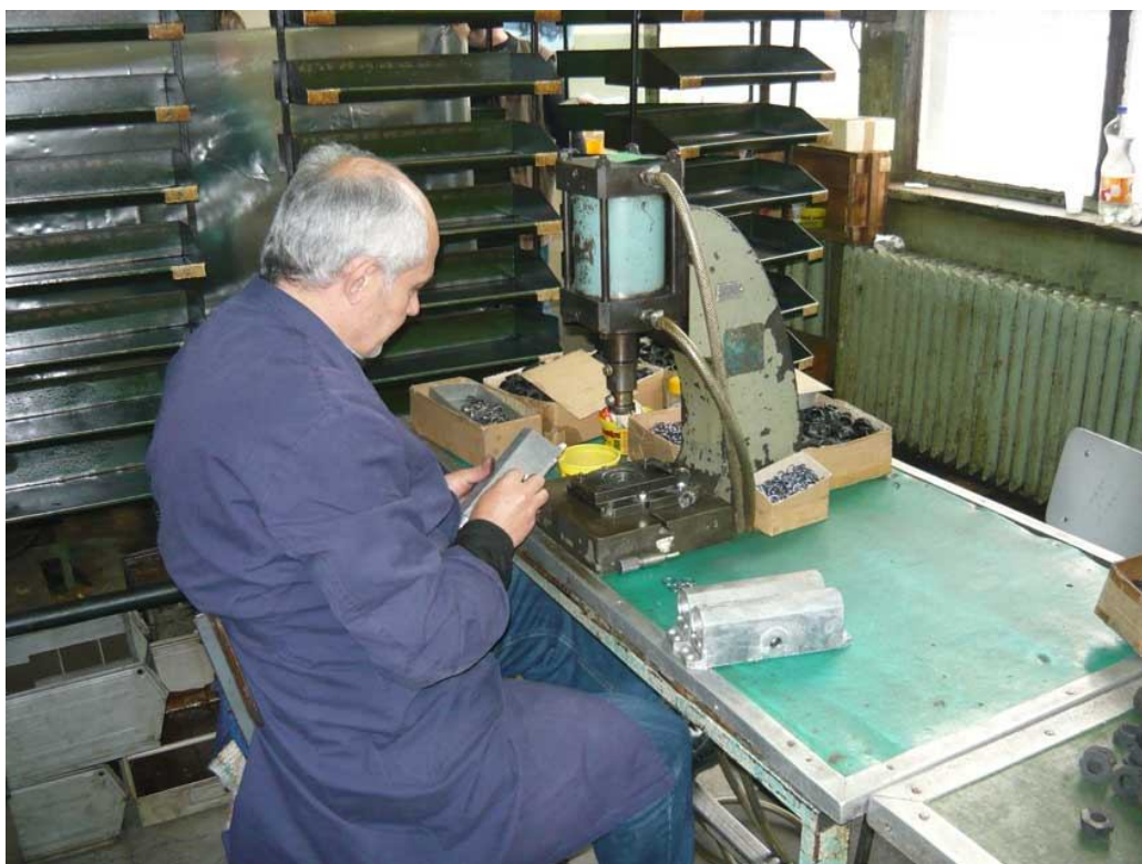
Слика 24 – Набијање лежаја и убацивање заптивне гумице, Циклус 2, Узорак 3, Београд
