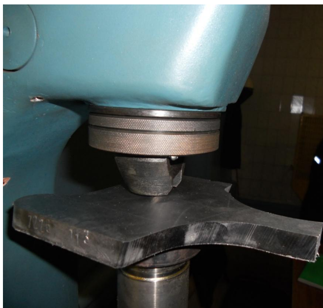
Slika 6.2.2.2. Mernje tvrdoće po poprečnom preseku venca, oboda i spojke točka na stacionarnom mernom uređaju Brinel metodom [30] 74
