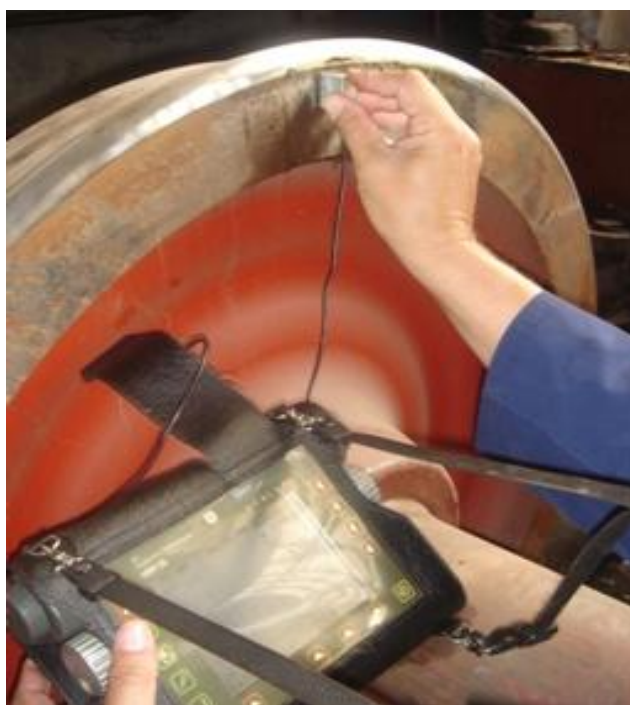
Slika 7.4.1. Ultrazvučna defektoskopija obnovljenog venca monoblok točka kvaliteta ER7
