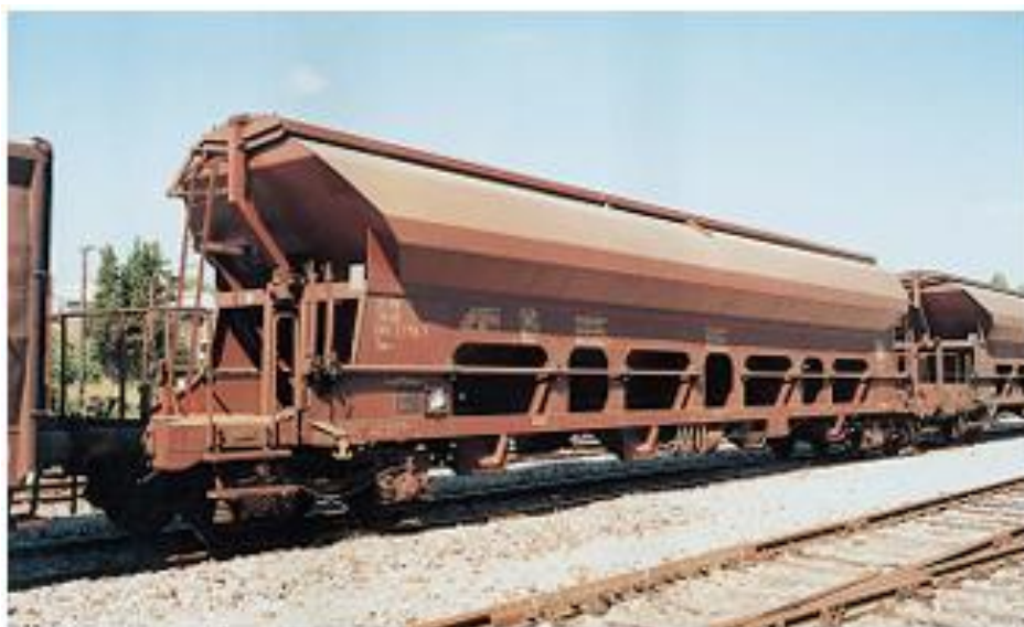
Slika 9.1.1. Terceni vagon serije Uaddf zž broj 86 44 934 6002-1, u procesu eksploatacionog istraživanja
