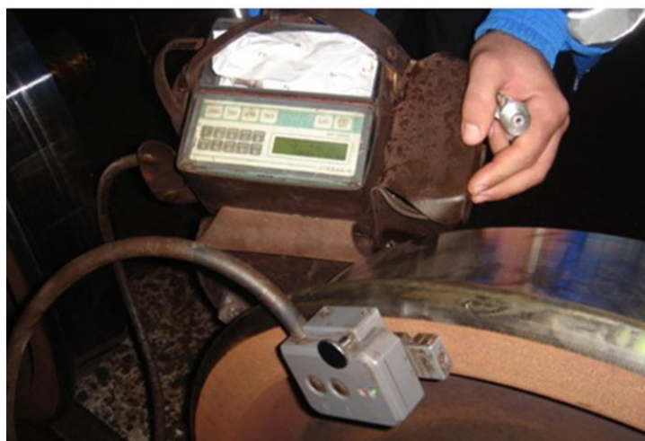
Slika 7.5.1. Ispitivanje zaostalih napona u vencu i obodu točka nakon navrivanja
