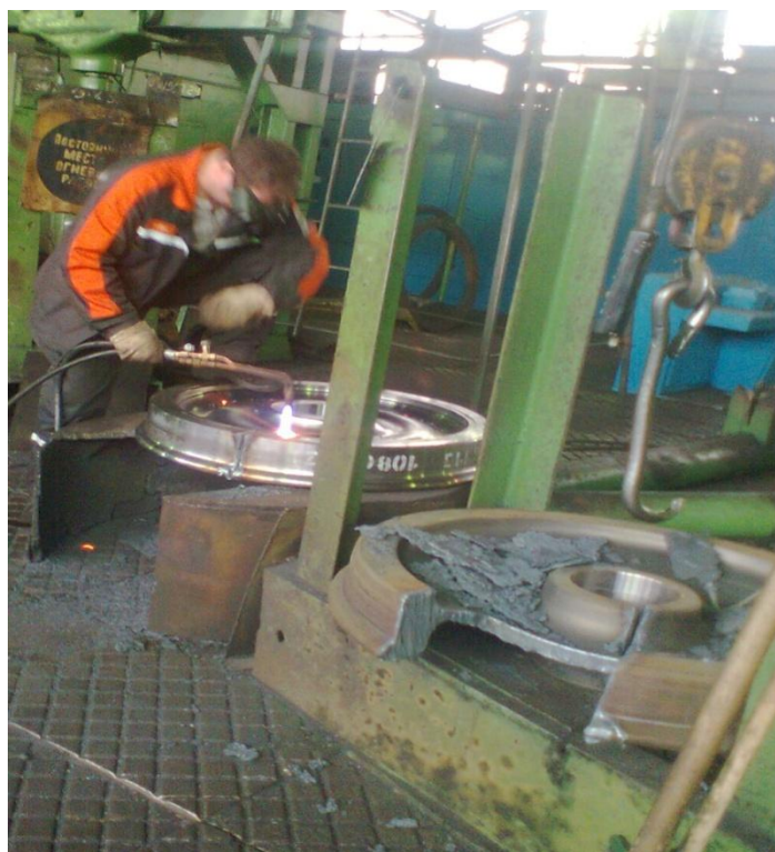
Slika 6.1.2. Gasno rasecanje monoblok točka za ispitivanja smera sopstvenih napona[31] 73
