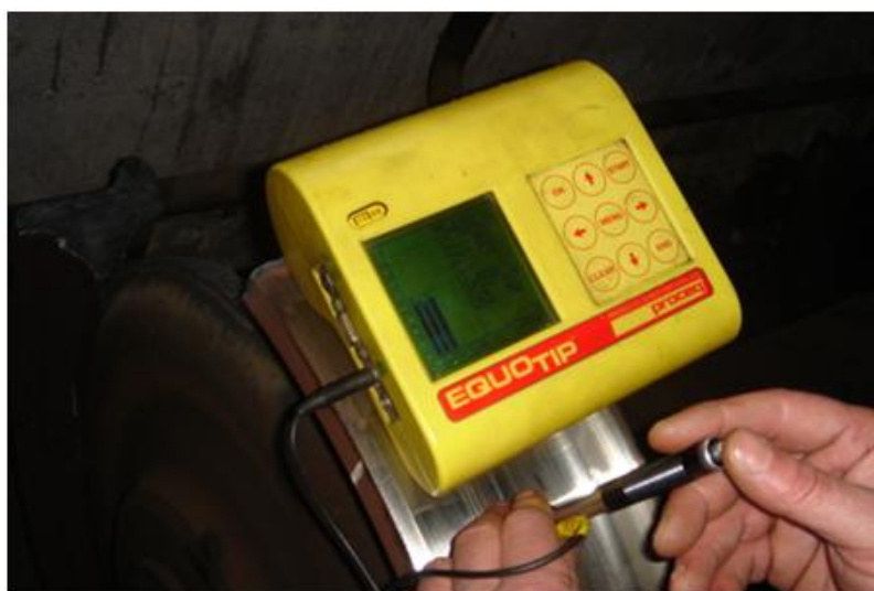
Slika 7.3.1. Merenje površinske tvrdoće profila kotrljanja i venca točka metodom UCI odskoka
