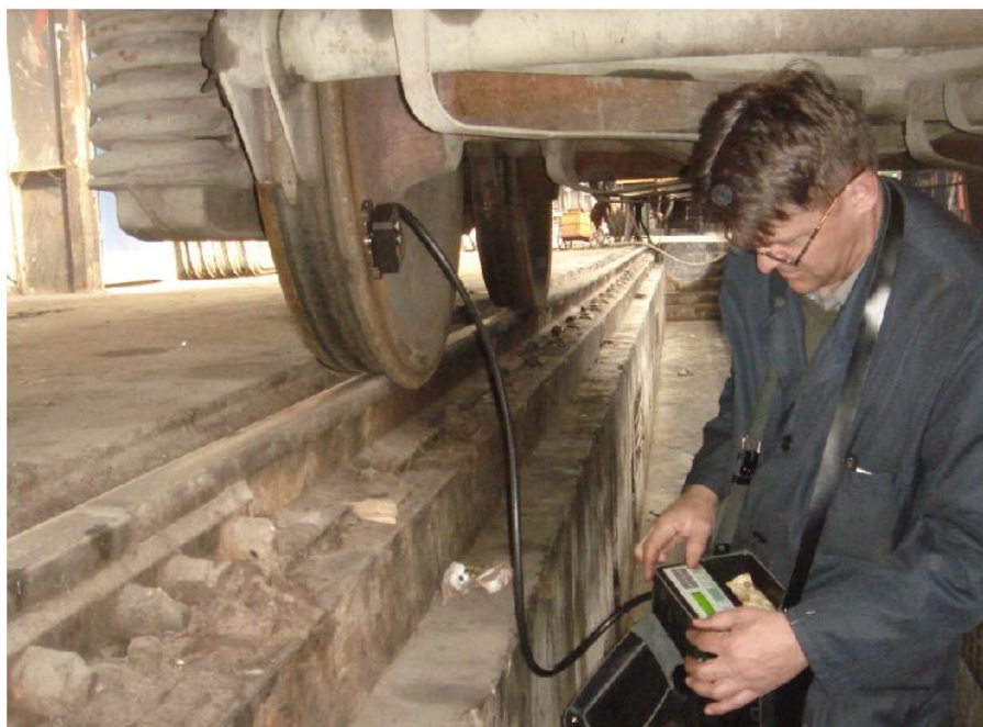
Slika 10.4.1. Merenje zaostalih napona u eksperimentalno-eksploatacionim točkovima procesom eksploatacije u tromesečnom periodu za dve godine
