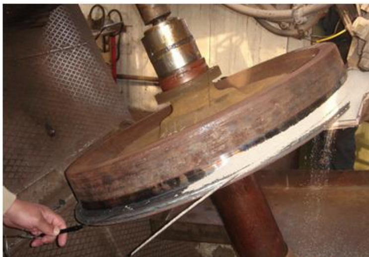
Slika 4.4.7.4. Nanošenje završnog navara
