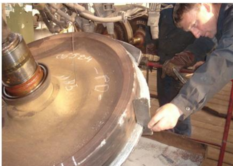
Slika 4.4.7.5. Kontrola efektivne količine navara na vencu monoblok točka
