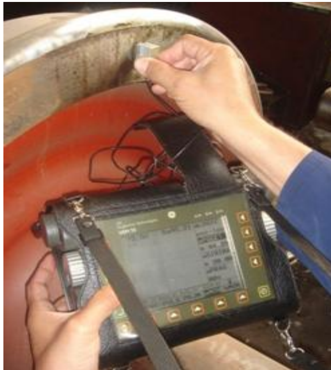
Slika 4.3.1.5.4. Ispitivanje grešaka u materijalu oboda i venca monoblok točka pre primene novog tehničko-tehnološkog postupka-navarivanjem
