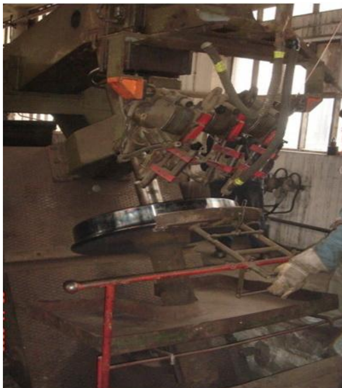
Slika 4.4.6.1. Namenski prihvatno-obrtni i nagibni uređaj osovinskog sklopa
