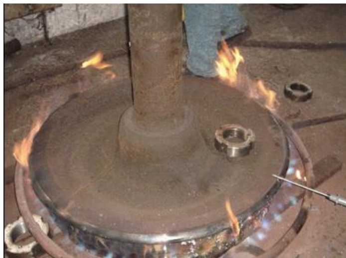
Slika 4.4.1.1. Plameno predgrevanje oboda i venca eksperimentalnog monoblok točka
