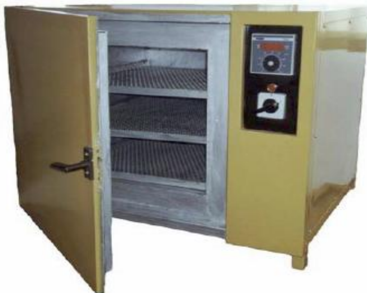
Slika 4.4.4.1. Peć za skladištenje i sušenje dodatnog i zaštitnog materijala za navarivanje venca monoblok točka
