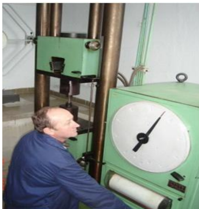
Slika 6.3.4. Ispitivanje mehaničke karakteristike zatezanjem [33] 76
