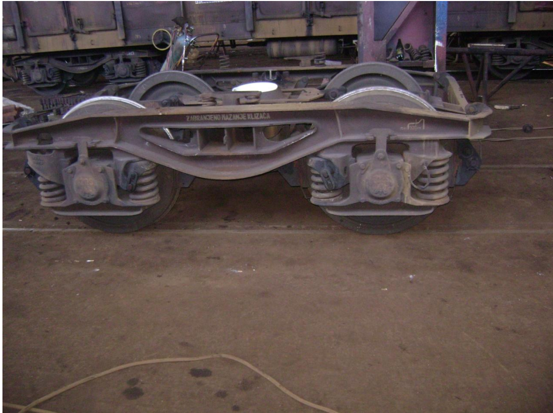
Slika 4.1.1. Obrtno postolje železničkog vagona na kome su ugrađeni eksperimentalni osovinski sklopovi
