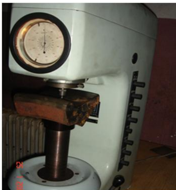
Slika 6.2.1.2. Ispitivanje tvrdoće eksperimentalnih uzoraka po poprečnom preseku venca točka: u zoni navara, osnovnog i materijala u ZUT
