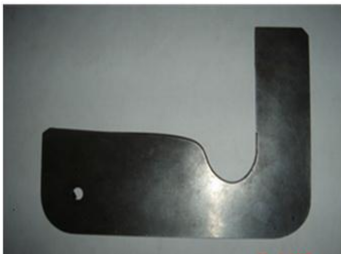
Slika 4.4.7.2. Merka za kontrolu količine navara na vencu točka
