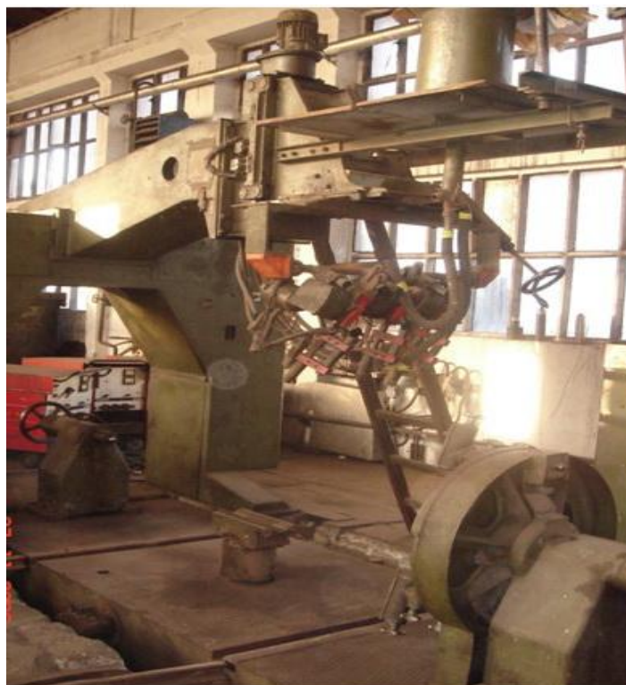
Slika 4.4.5.1. Postrojenje za navarivanje venca monoblok točka tipa RS 3/1
