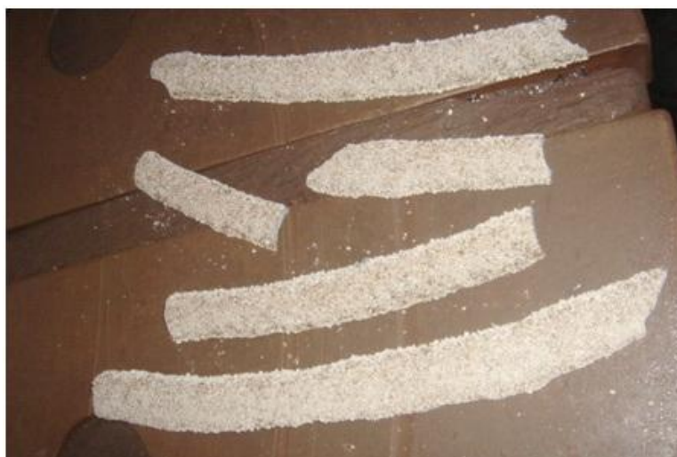
Slika 4.4.8.1. Zaštitna troska: izgled, čistoća, geometrijski oblik i ujednačenost debljine
