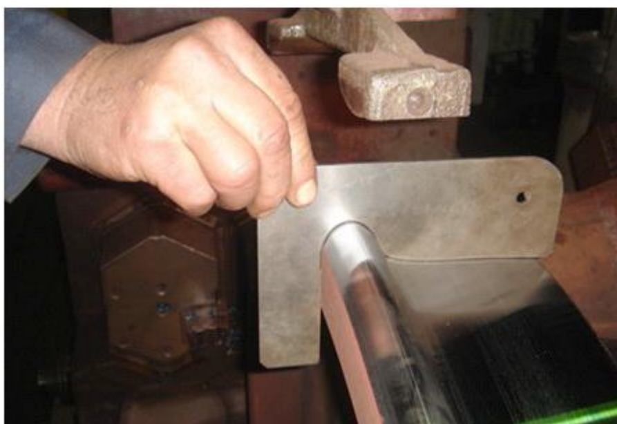
Slika 7.2.2. Kontrola oblika profila venca monoblok točkova nakon mašinske obrade
