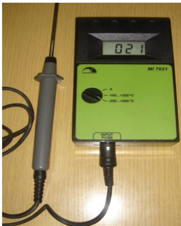
Slika 4.4.1.2. Primenjeni termometar za merenje temperature predgrevanja
