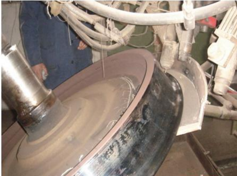
Slika 4.4.6.2. Regulacija mašine i osovinskog sklopa za proces navrivanja venca monoblok točka kvaliteta materijala ER7
