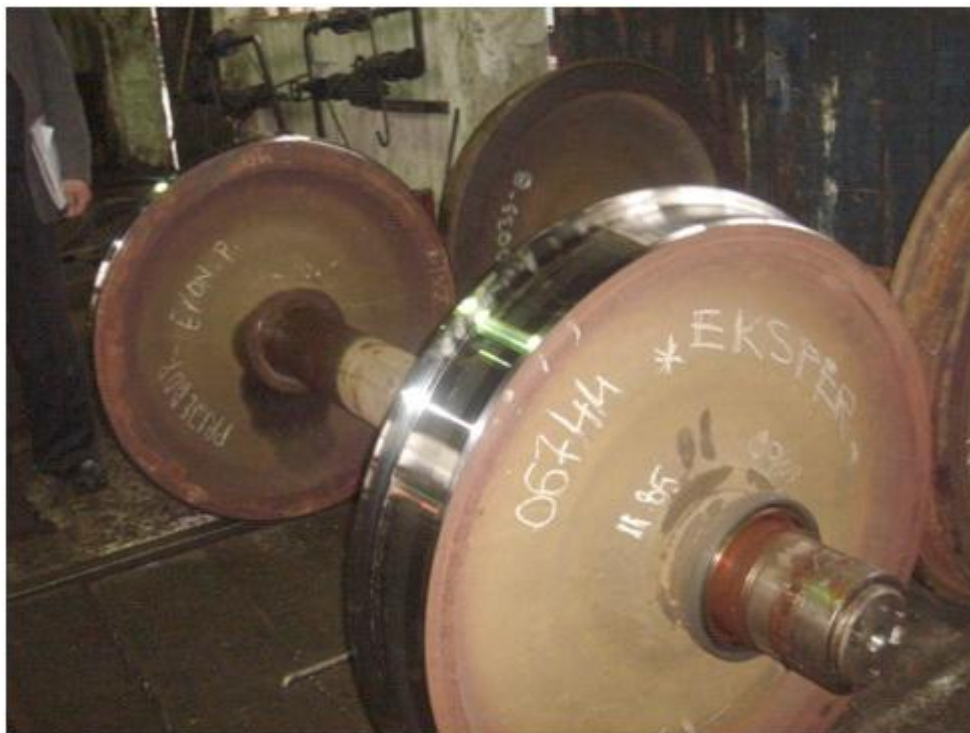
Slika 4.1.2. Eksperimentalni osovinski sklopovi sa navučenim točkovima kvaliteta ER7, prečnika Ø 920 mm
