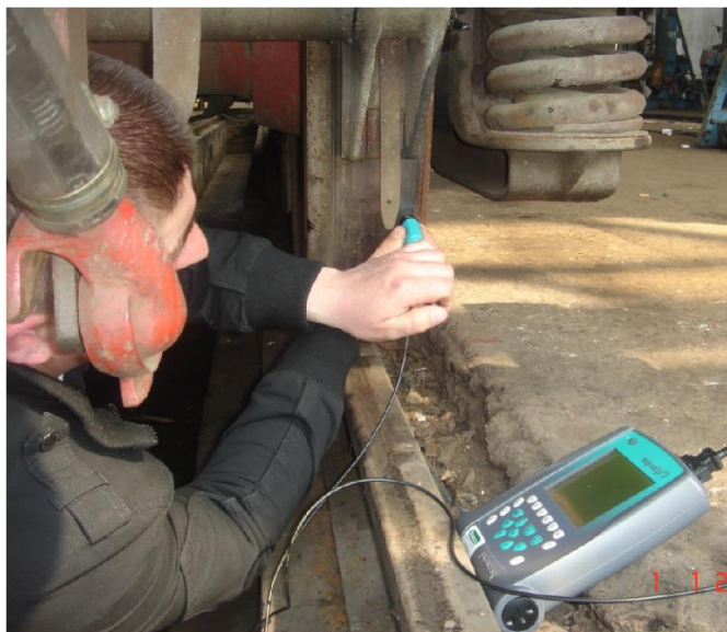
Slika 10.2.2. Ispitivanje površinske tvrdoće profila točka u radioničkim uslovima
