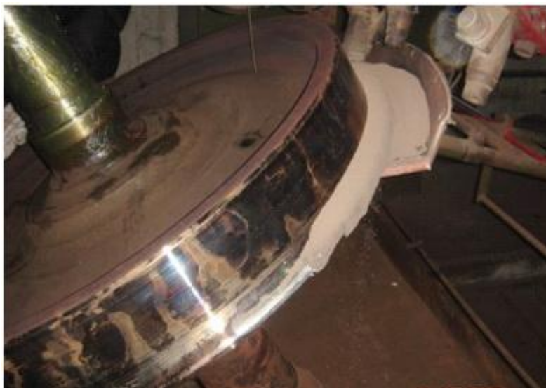
Slika 4.4.7.3. Tehnološki proces nanošenja prvog navara na venac monoblok točka
