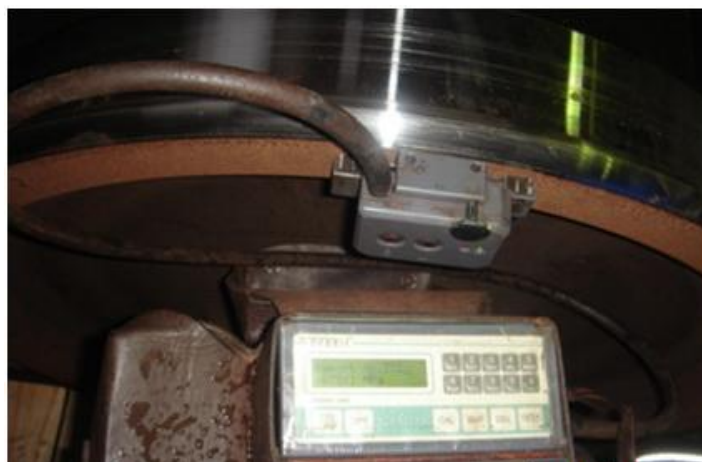
Slika 4.3.1.6.2. Ultrazvučni dijagnostički uređaj za merenje zaostalih napona u obodu i vencu monoblok točka pre navarivanja
