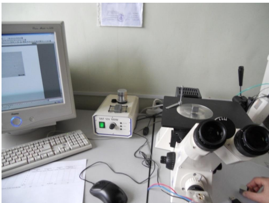
Sika. 6.6.2.1. Analiza mikroizbrusaka na elektronskom metalografskom mikroskopu[31] 82
