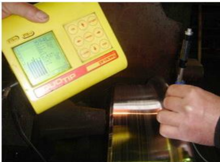
Slika 4.3.1.3.1. Ispitivanje površinske tvrdoće mobilnim uređajem sa malim opterećenjima merne igle
