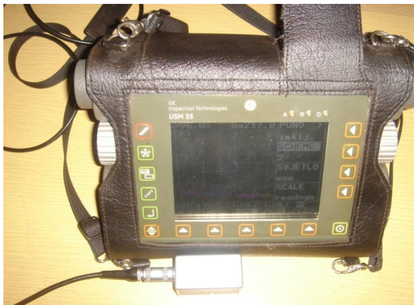
Slika 4.3.1.5.2. Ultrazvučni defektoskopski aparat korišten pri pocesu sprovođenja eksperimentalnog i eksploatacionog istraživanja
