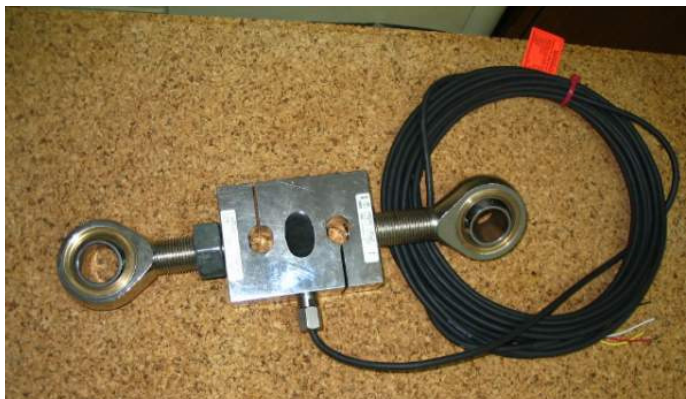
Slika 25. Merna ćelija HBM RSCA C3/5t
