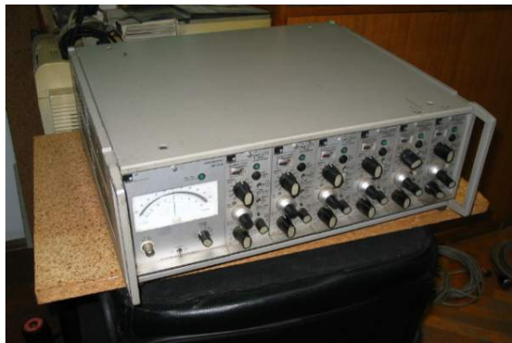
Slika 26. Analogno univerzalno merno pojačalo HBM KWS 673.A2
