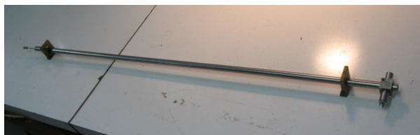
Slika 23. Induktivni davač pomeranja sa kotvom HBM W 200
