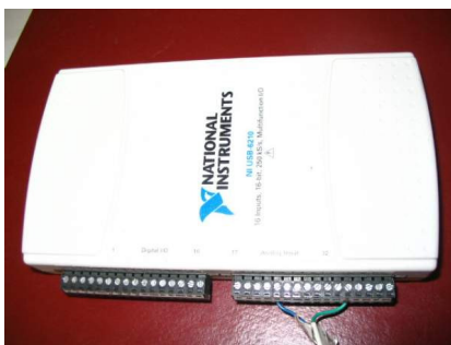
Slika 27. Akviziciona kartica National Instruments NI USB-6210
