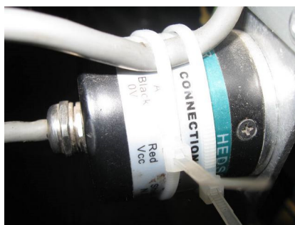
Slika 24. Rotacioni inkrementalni enkoder HEDSS
