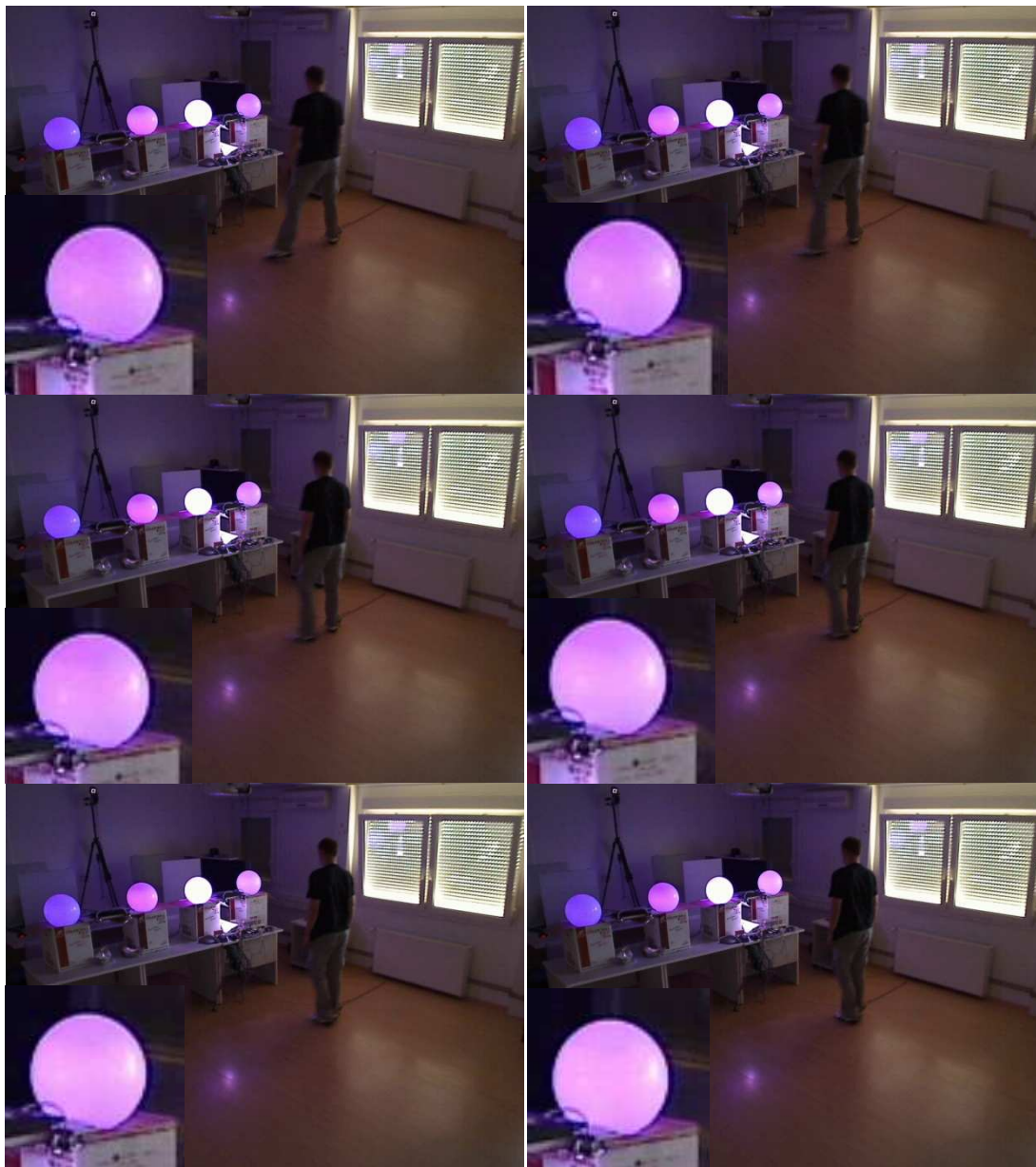
Slika 120. Šest uzastopnih frejmova iz ispitnog Slučaja C: Na slici se vidi zavisnost osvetljenosti lampe od ulaska korisnika u zonu lampe u svakom frejmu
