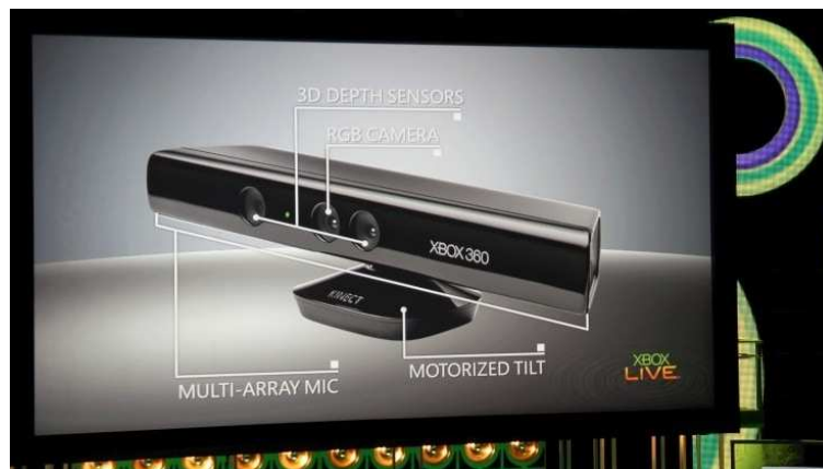
Slika 17. Kinect uređaj sa označenim senzorima (slajd sa Microsoft E3 konferencije)
