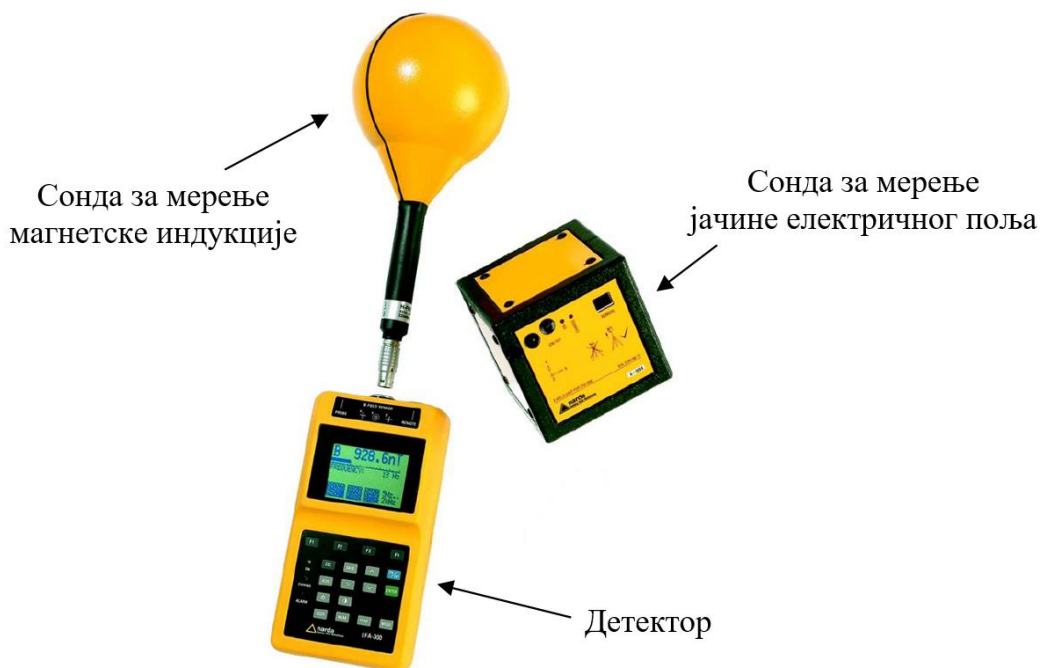
Слика 3.1. Систем за мерење електричног поља и магнетске индукције – анализатор електромагнетског поља EFA-300 (тип BN 2245/30) с екстерним сондама за мерење јачине електричног поља (тип BN 2245/90.31) и магнетске индукције (тип BN 2245/90.10) [81], [82]
