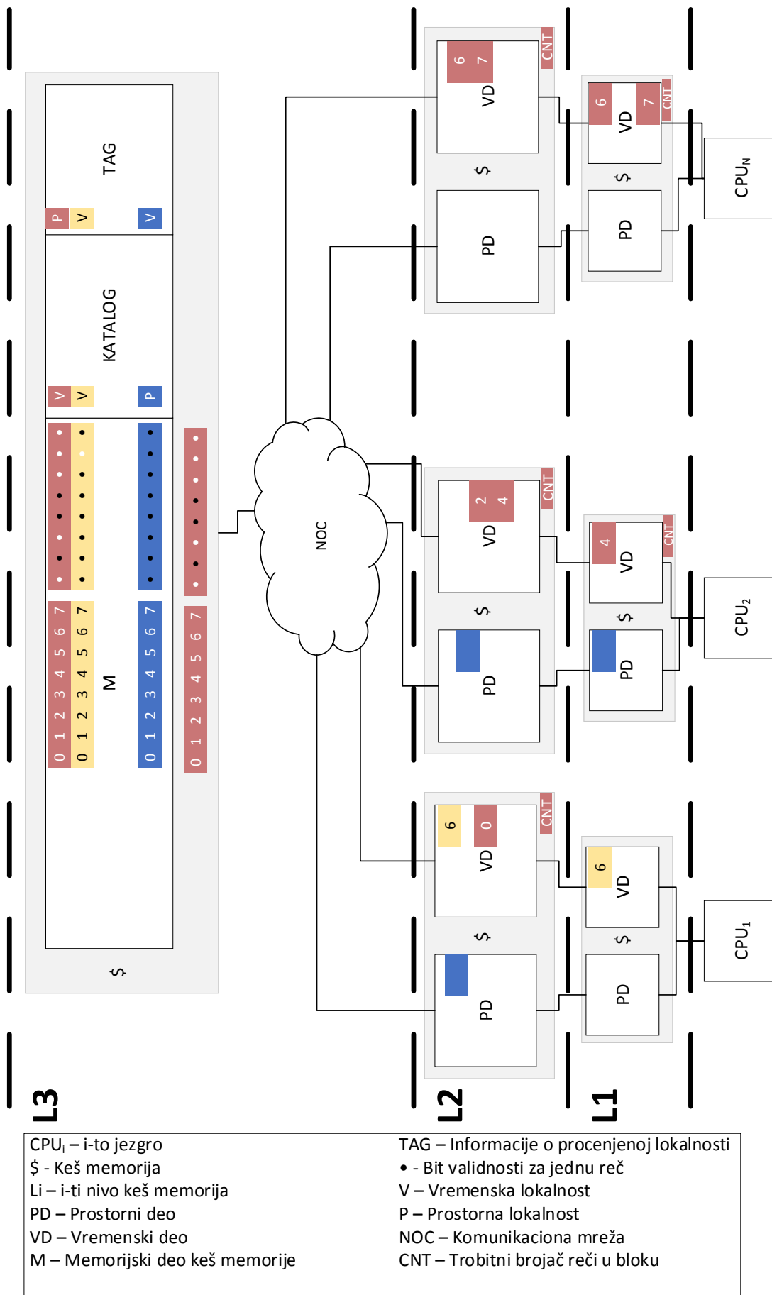
Slika 5.7: Organizacija podjeljenog keš podsistema u višejezgardnom procesoru
