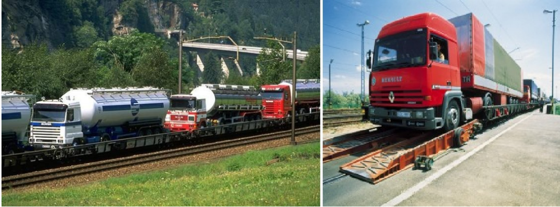
Slika 2.5. Tehnologija bimodalnog transporta Ro-La
