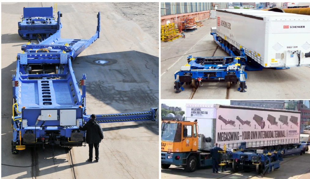
Slika 2.6. Tehnologija bimodalnog transporta tipa MEGASWING
