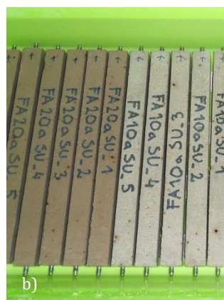
Slika VI-33. Izlaganje malterskih epruveta dejstvu sulfatnog rastvora: a) Spravljanje sulfatnog rastvora b) Uzorci u sulfatnom rastvoru
