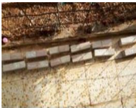
Slika V-11. Nega saniranih uzoraka u vrućim klimatskim uslovima [13]
