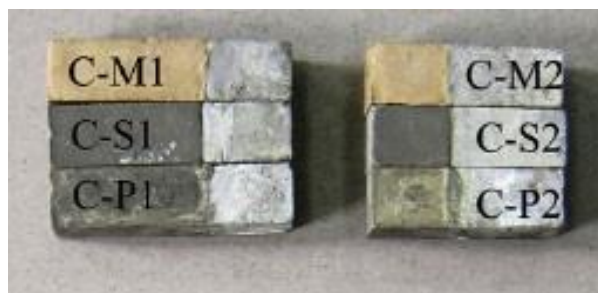
Slika V-7. Sanirani uzorci: levo – prizme dimenzija 40 mm×40 mm×160 mm, desno - prizme dimenzija 40 mm×40 mm×140 mm [134]
