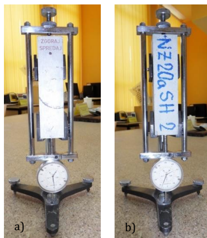
Slika IV-5. Ispitivanje skupljanja usled sušenja reparaturnog maltera: a) Oprema, b) Ispitivanje uzorka
