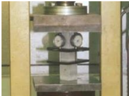
Slika IV-6. Ispitivanje sekantnog modula maltera [140]
