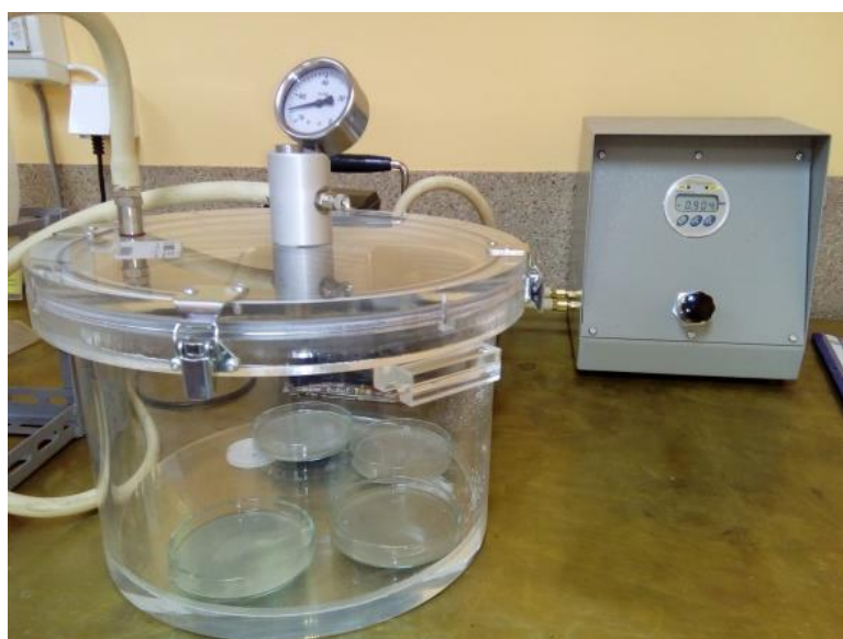
Slika VI-26. Vakumiranje adekvatno pripremljenih uzoraka pasta
