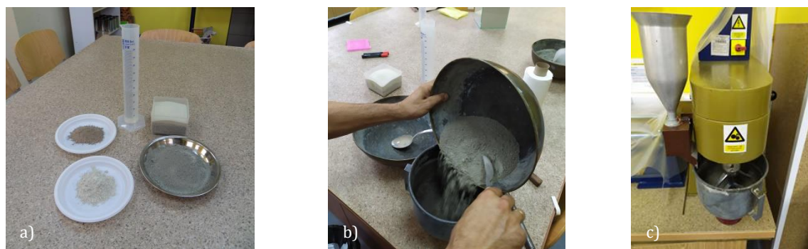
Slika VI-14. Primer spravljanja malterskih prizmi: a) Komponentni materijali, b) Dodavanje veziva u tečnu fazu, i c) Miksiranje
