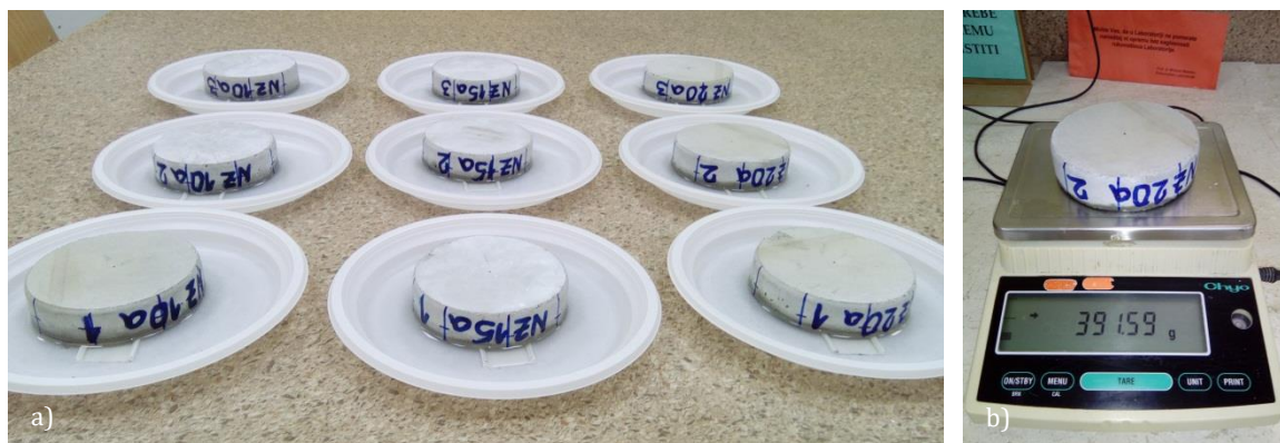
Slika VI-28. Ispitivanje kapilarnog upijanja vode
