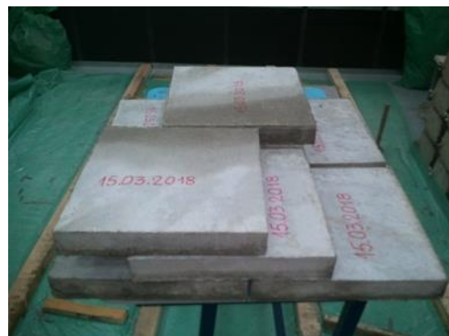
Slika VI-11. Izrada betonskih podloga i kocki: a) Beton ugrađen u kapule, b) Podloge nakon vađenja iz kalupa
