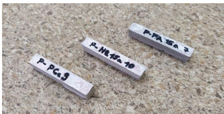
Slika VI-19. Primeri ugrađenih pasta u kalupe dimenzija 10×10×60 mm
