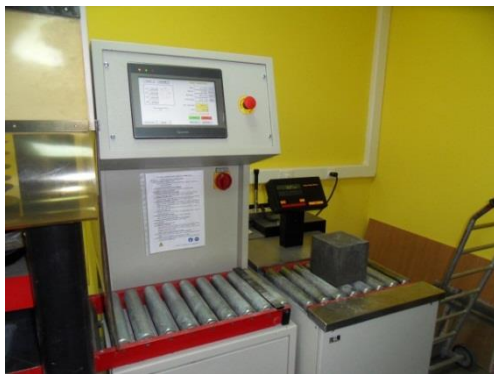
Slika VI-12. Ispitivanje čvrstoće pri pritisku kocki od referentnog betona starosti 28 dana: a) Merenje mase kocke b) Uzorak nakon ispitivanja
