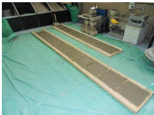
Slika VI-11. Izrada betonskih podloga i kocki: a) Beton ugrađen u kapule, b) Podloge nakon vađenja iz kalupa
