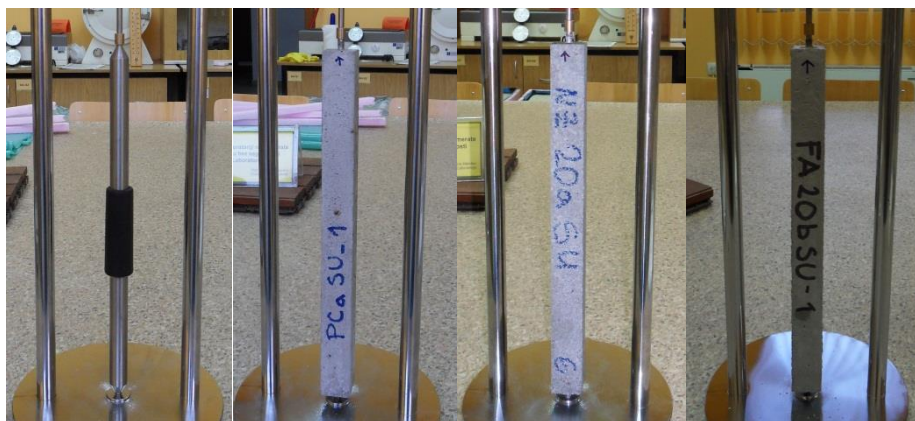
Slika VI-34. Merenje promene dužine malterskih epruveta usled dejstva sulfatnog rastvora
