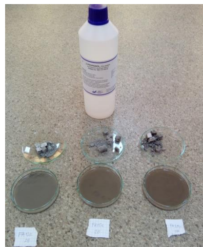
Slika VI-25. Zaustavljanje procesa hidratacije primenom izopropanola
