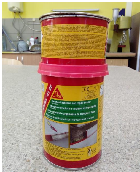
Slika VI-22. Dvokomponentni lepak za lepljenje pečata
