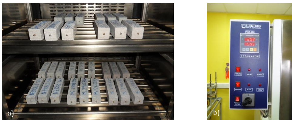
Slika VI-30. Nega uzoraka maltera u toku ispitivanja skupljanja usled sušenja u klima-komori: a) Unutrašnjost komore sa uzorcima, i b) Kontrolna tabla
