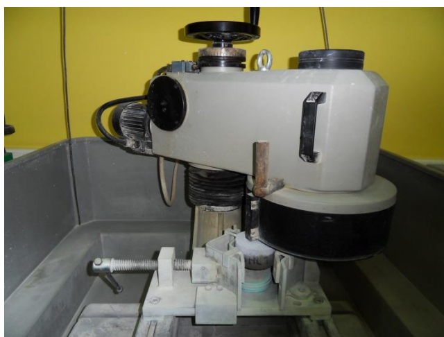
Slika VI-20. Mašina za finu pripremu uzoraka brušenjem
