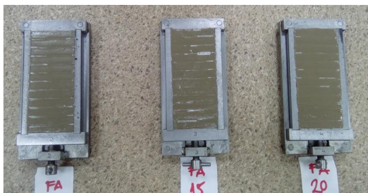
Slika VI-17. Primeri ugrađenih pasta u kalupe dimenzija 10×10×60 mm
