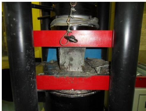
Slika VI-12. Ispitivanje čvrstoće pri pritisku kocki od referentnog betona starosti 28 dana: a) Merenje mase kocke b) Uzorak nakon ispitivanja
