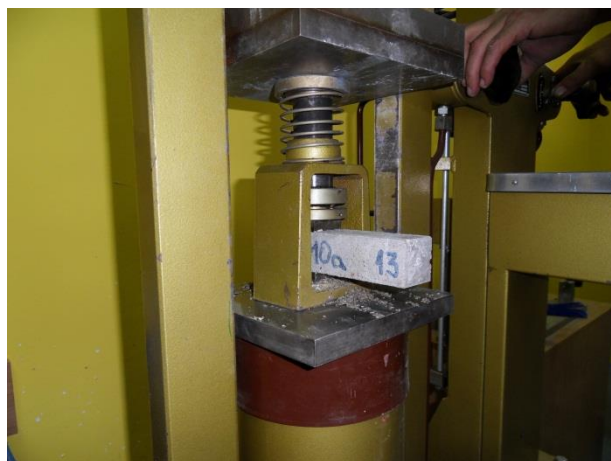
Slika VI-27. Određivanje čvrstoće pri pritisku maltera
