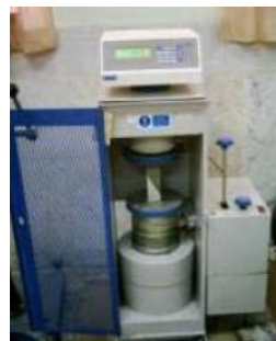
Slika V-13. Ispitivanje saniranog uzorka na koso smicanje [12]
