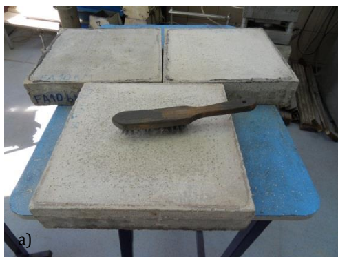
Slika VI-21. Priprema površine maltera (sanirani uzorci) za lepljenje pečata: a) Tretiranje test-površine žičanom četkom, i b) Označavanje položaja za lepljenje pečata
