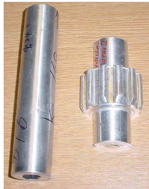
Slika 2.8 - Pripremak i gotov deo dobijen metodom radijalnog istiskivanja uz delovanje dodatnog pritiska [58]
