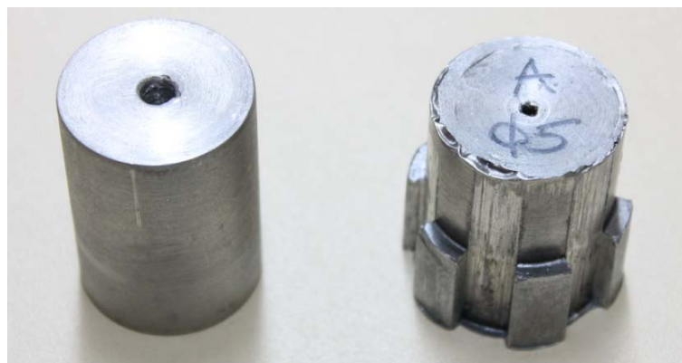
Slika 4.11 - Tip ozubljenja A model deformisanja OP otvor \phi 5\text{mm}
