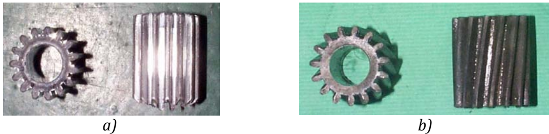
Slika 2.5 - Istiskivanje cilindričnih zupčanika sa kosim zubima a) izgled dela nakon prve faze b) izgled dela nakon druge faze [45]
