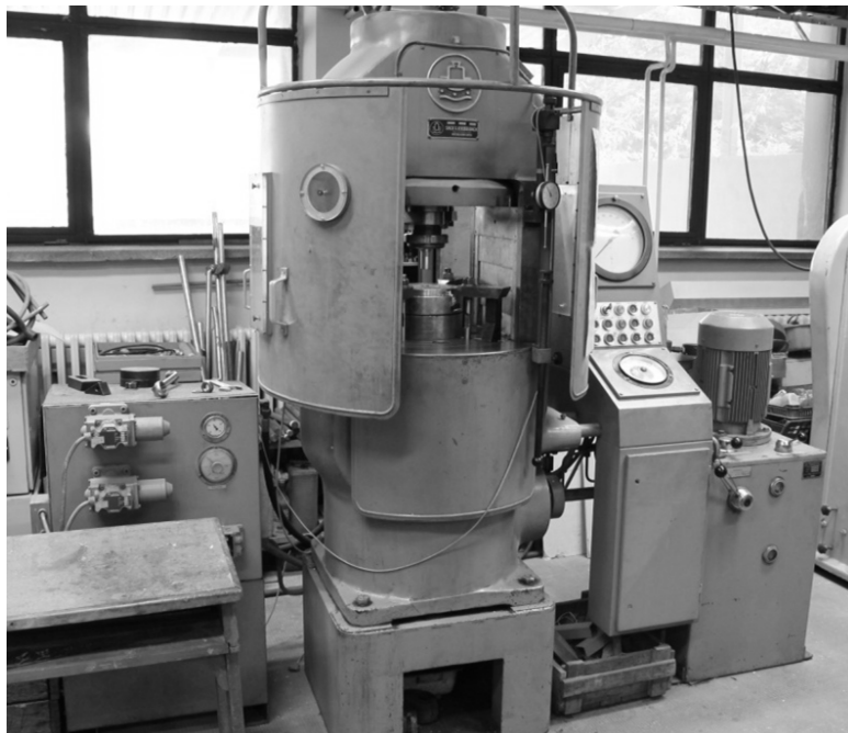
Slika 4.1 - Hidraulična presa Sack & Kiesselbach, nominalne sile 6,3 MN
