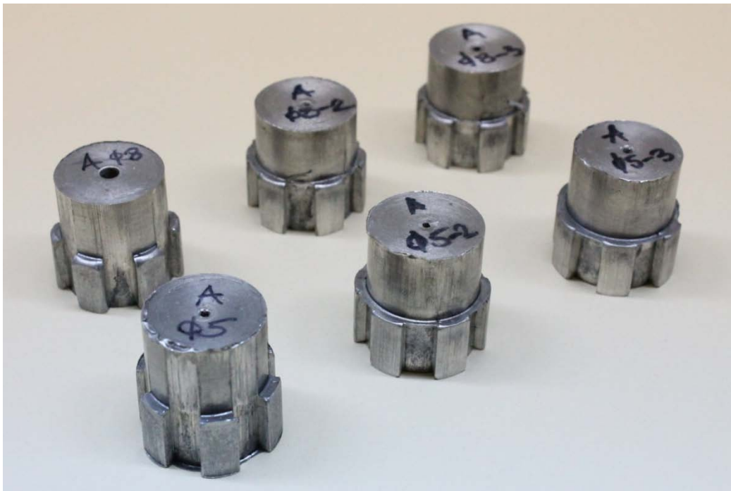
Slika 4.13 - Uzorci iz eksperimenta istiskivanja tipa ozubljenja A, model deformisanja OP
