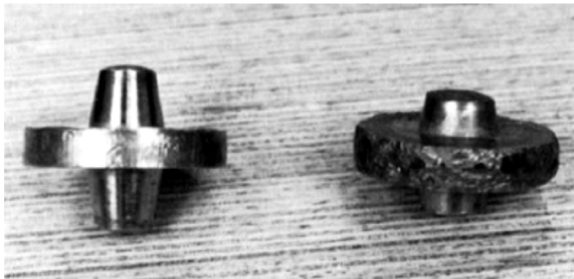
Slika 2.26 - Deo dobijen kombinacijom sabijanja i istiskivanja [15]
