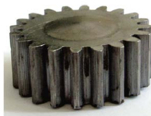
Slika 2.6 - Cilindrični zupčanik dobijen istiskivanjem žigom sa konusnim udubljenjem [41]
