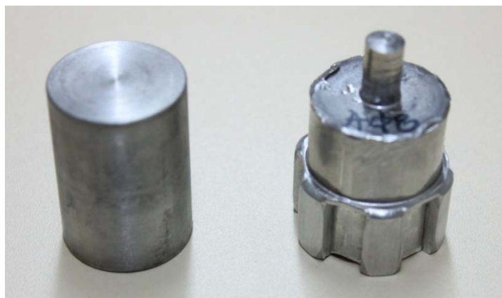
Slika 4.16 - Tip ozubljenja A model deformisanja OA otvor \phi 8 mm
