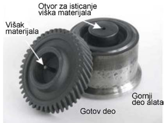
Slika 2.27 - Primena otvora u alatu kod toplog kovanja cilindričnih zupčanika sa kosim zubima [12,14]
