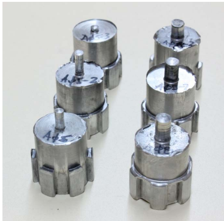
Slika 4.17 - Uzorci iz eksperimenta istiskivanja tipa ozubljenja A, model deformisanja OA
