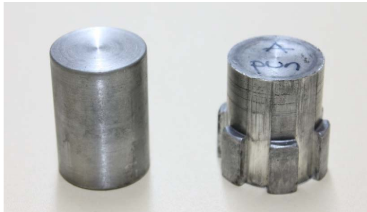
Slika 4.9 - Pripremlju i gotov deo -tip ozubljenja A, pun deo
