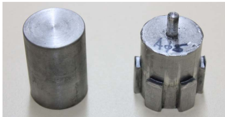
Slika 4.15 - Tip ozubljenja A, model deformisanja OA otvor \phi 5\text{mm}
