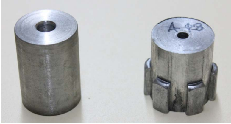
Slika 4.12 - Tip ozubljenja A model deformisanja OP otvor \phi 8 mm
