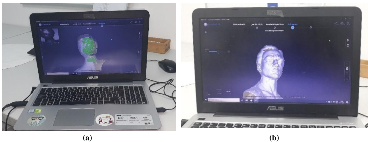
Slika 34. Prikupljeni oblak tačaka 3D skeniranjem: a) u toku prikupljanja; b) finalni oblak tačaka skulpture
