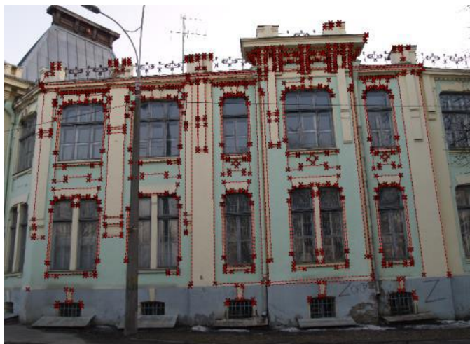
Slika 5. Primena fotogrametrije za arhitektonsko merenje – mere dobijene fotogrametrijom poklapaju se sa realnim [28]
