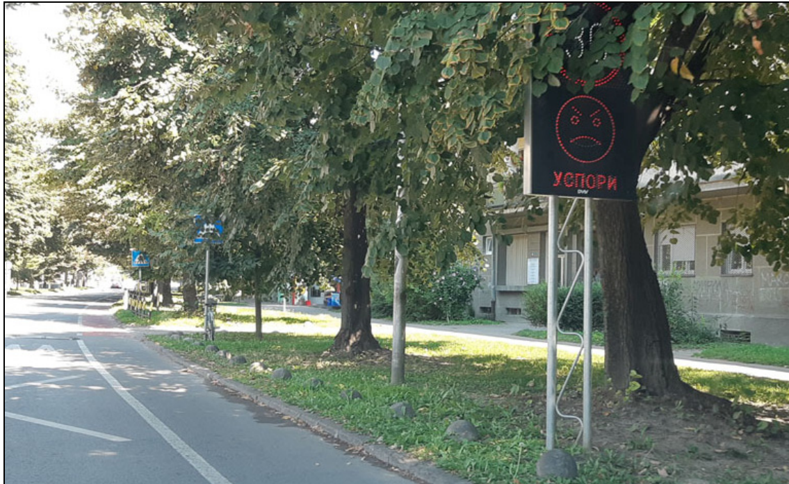
Слика 49. Саобраћајни знак са измењивим садржајем порука са радаром у Новом Саду код школе „Ђорђе Натошевић” (Извор: аутор).
