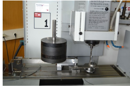
Slika 6.13. Uređaj za merenje nosivosti i popustljivosti kontakta između elemenata za stezanje i radnog predmeta u dinamičkim uslovima opterećenja.
