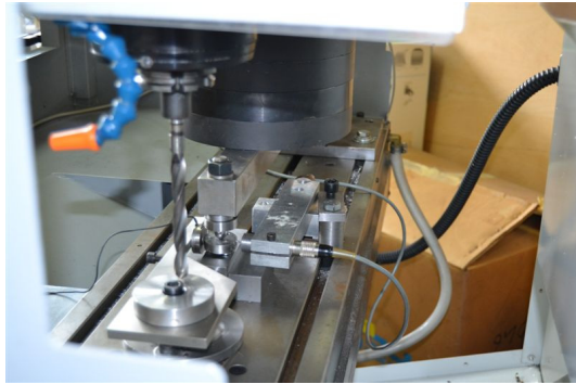
Slika 6.13. Uređaj za merenje nosivosti i popustljivosti kontakta između elemenata za stezanje i radnog predmeta u dinamičkim uslovima opterećenja.
