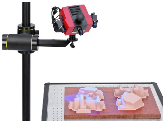
Slika 2.6: Primer optičkog industrijskog skenera - Atos Compact Scan 5M [24].
