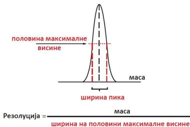
Слика. 4.33. Израчунавање резолуције пика [70]
