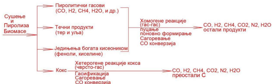
Слика 3.5. Шематски упрошћен приказ процеса гасификације биомасе [6]
