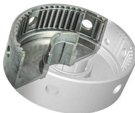
Slika 1.43 Bubanj kvačila (ISO JS/1050-6)
