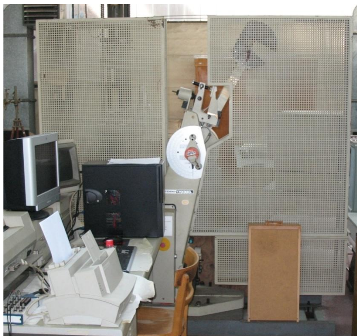
Slika 2.11 Instrumentirano Šarpijevo klatno (RPSW/A, Schenck-Treble, na Vojnotehničkom institutu, Beograd)
