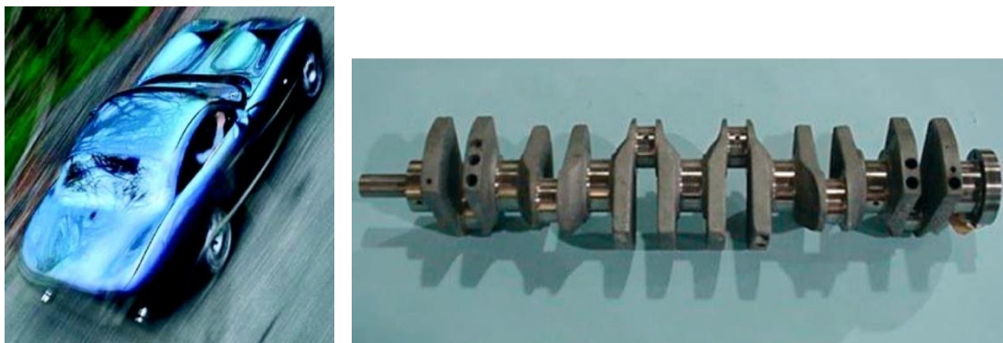
Slika 1.41 Kolenasto vratilo za motor automobila TVR Tuscan Speed 6 (cca. 700 mm i 30 kg) [TVR, UK]
