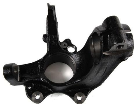
Slika 1.42 Spona točka izrađena od ADI materijala (EN-GJS-1000-5), Audi AG [188]
