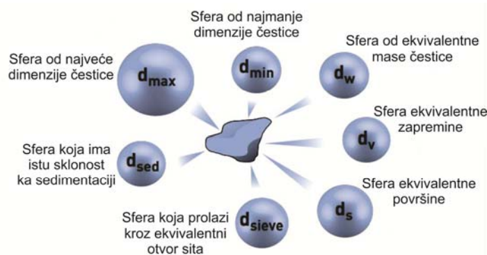
Slika 4.9 Ilustracija koncepta ekvivalentne sfere koji se primenjuju kod određivanja veličine čestice [70].
