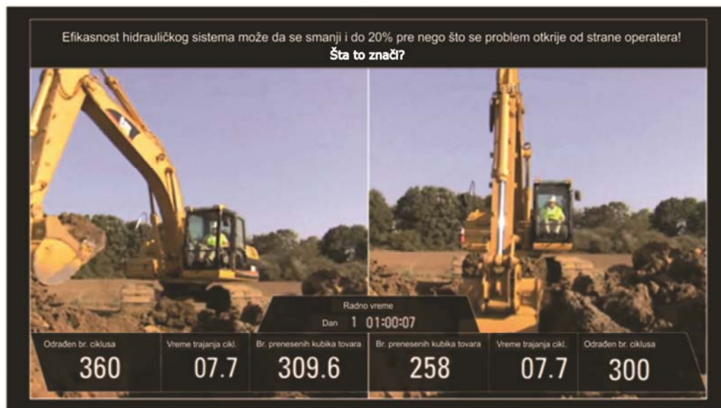
Slika 3.6 Efikasnost čistog (levo) i kontaminiranog (desno) hidrauličkog pogona bagera (Catepillar).
