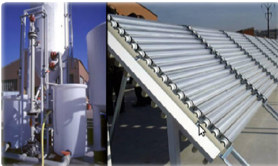
Slika 2. Solarno postrojenje za prečišćavanje voda „SOLARDETOKS” (Malato i dr., 2009)
