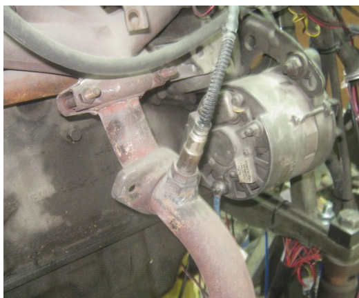
Sl. 7.14 Širokopojasna \lambda -sonda Bosch LSU 4.2 montirana na motor Yugo EFI 1.1
