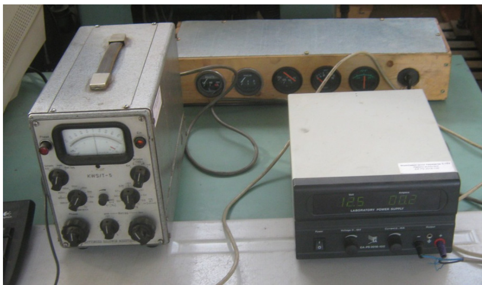
Sl. 7.9 Merno pojačalo KWS /T-5 sa napajanjem EA-PS 2016-100
