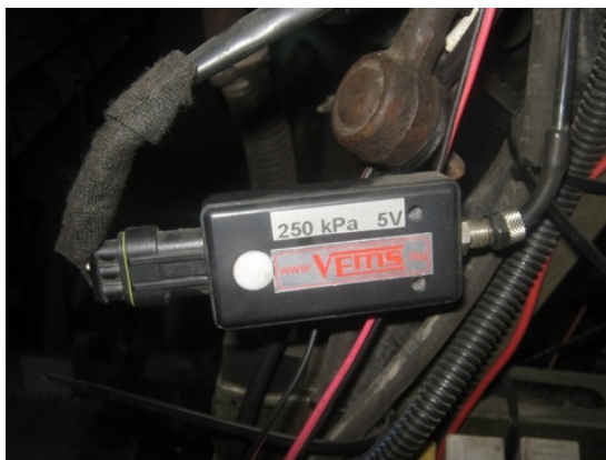
Sl. 7.13 Senzor apsolutnog pritiska u usisnom kolektoru VEMS MPXH6400
