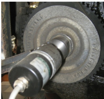
Sl. 7.11 Izgled montiranog enkodera HEDSS ISC 3806
