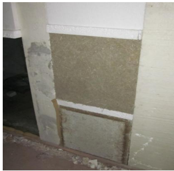
Слика 4.3.8.1. а) и б) Одређивање топлотне проводљивости материјала (Фото: Милица Мирковић Марјановић)
