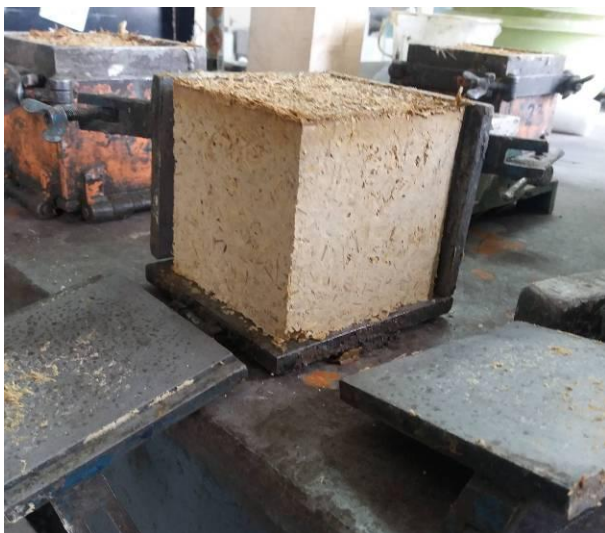
Слика 4.3.5.1. а) и б) Раскалупљивање узорака (Фото: Ивана Шеклер)
