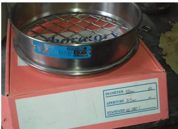
Слика 4.3.1.1. Коришћено грађевинско сито (Фото: Ивана Шеклер)
