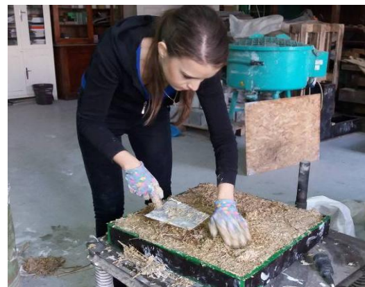
Слика 4.3.4.2. Уграђивање смесе у калуп (Фото: А.Костић)
