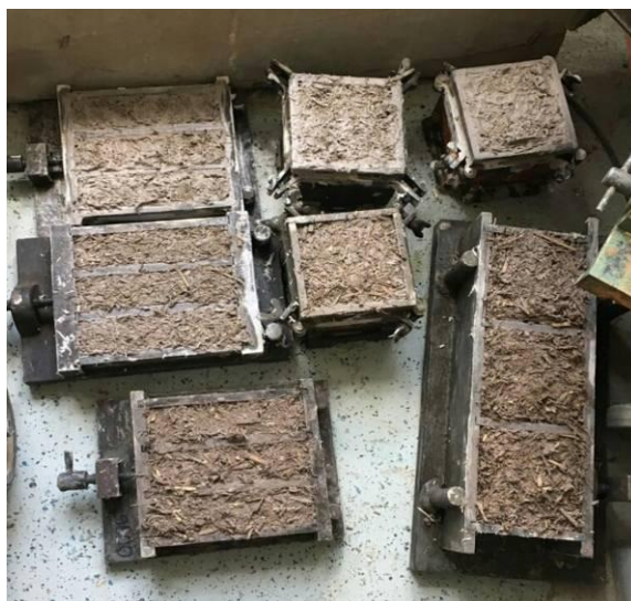
Слика 4.3.4.4. Припремљени узорци у калупима (Фото: Ивана Шеклер)
