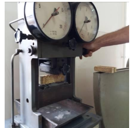
Слика 4.3.6.5. Одређивање чврстоће при затезању призми (Фото: И. Шеклер)
