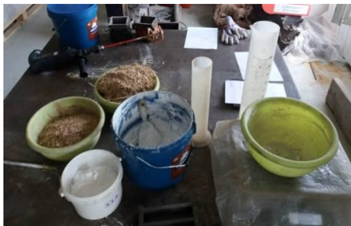
Слика 4.3.2.1. Одмеравање потребних материјала (Фото: Ивана Шеклер)
