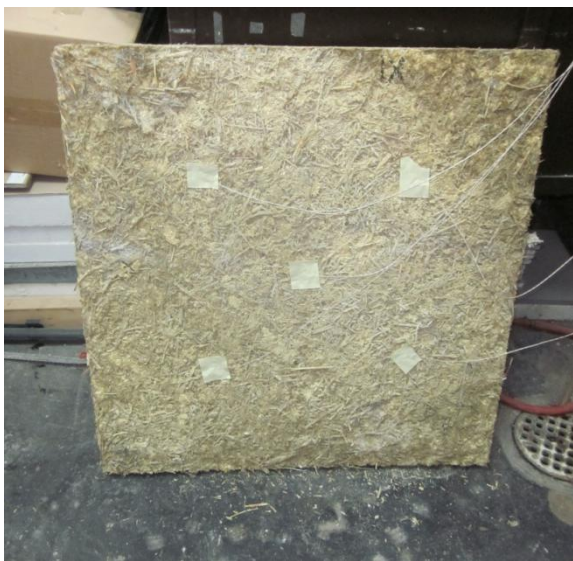
Слика 4.3.8.1. а) и б) Одређивање топлотне проводљивости материјала (Фото: Милица Мирковић Марјановић)
