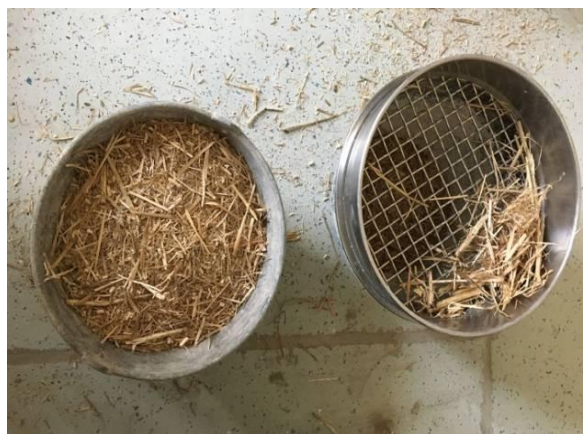
Слика 4.3.1.2. Просејавање мискантуса (Фото: Ивана Шеклер)
