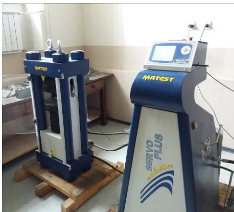
Слика 4.3.6.4. а) аутоматизована хидраулична преса, б) одређивање чврстоће при притиску за узорке облика коцке (Фото: И. Шеклер)
