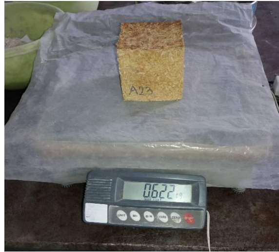
Слика 4.3.6.3. Мерење масе узорка након сушења ван калупа (Фото: И.Шеклер)
