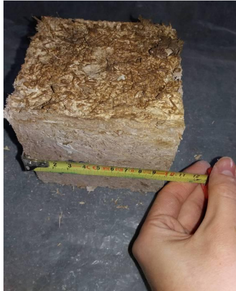
Слика 4.3.6.1. Мерење димензија узорка (Фото: Ивана Шеклер)
