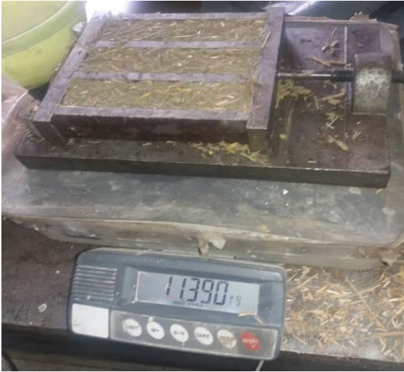
Слика 4.3.6.2. Мерење масе узорка након уградње у калупе (Фото: И. Шеклер)
