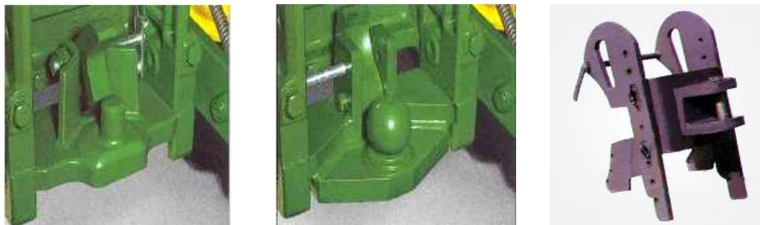
Слке 5.8, 5.9 и 5.10. Повезивање помоћу куке или вијка
