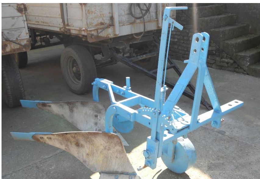
Слика 5.21 Плуг превртач типа OLT PTO-2.25
