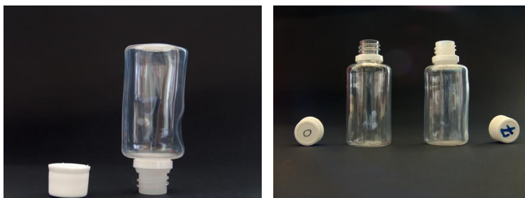
Slika 109. Vizuelne promene na bocama nakon testa starenja
