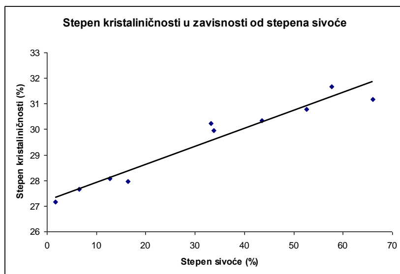
Slika 131. Linearna zavisnost stepena sivoće i krstaliničnosti
