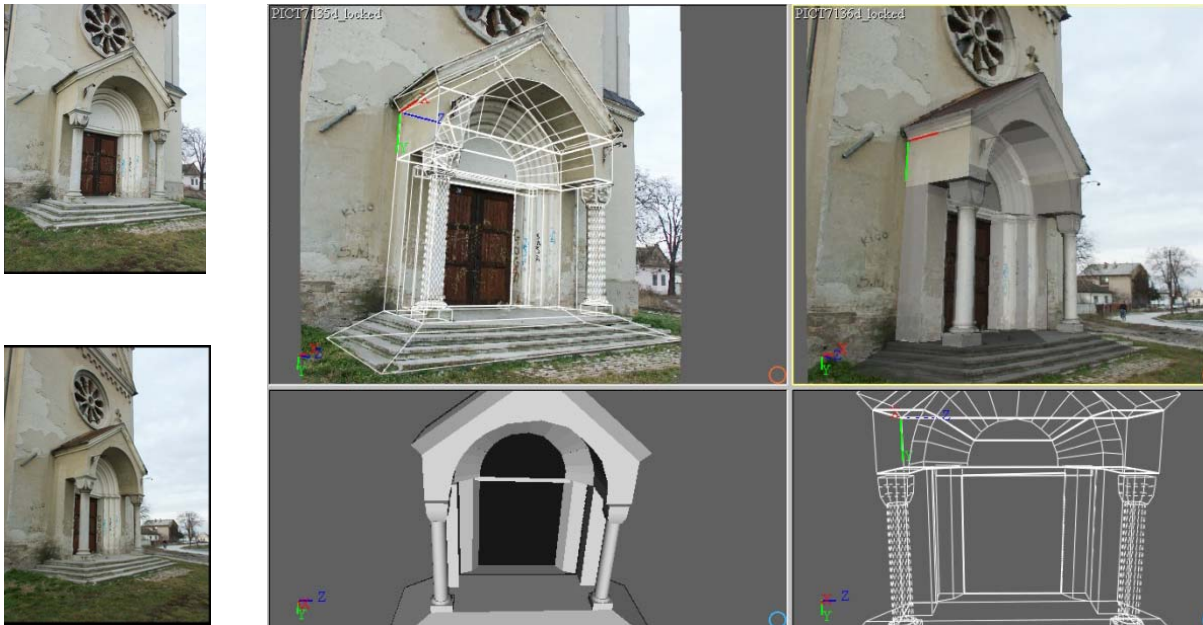
Slika 122. Model koji kreira korisnik umetanjem jednostavnih tela, crkva Srca Isusovog u Apatinu (V. Stojaković).
