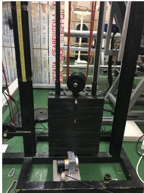
Slika 4. Pozicija linearnog enkodera sa sajlom.
