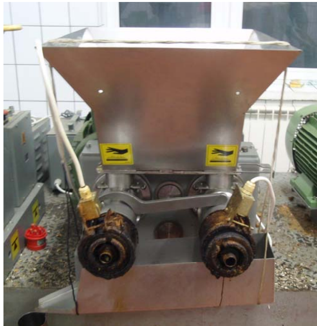
Slika 19. Pužna presa za hladno presovanje semena uljarica (Proizvođač: Kern Kraft, Nemačka)
