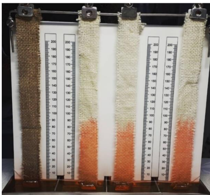
Slika 6.1. Aparatura za određivanje kapilarnosti tkanine od jute
