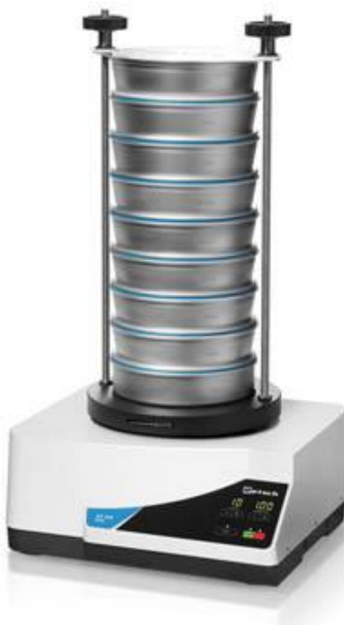
Slika 8. Sistem za vlažno prosejavanje uzoraka sedimenata
