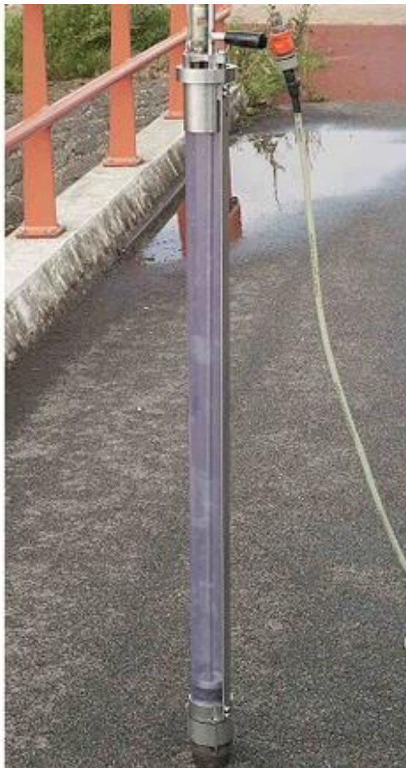
Slika 7. Kor uzorkivač sedimenta-proizvođača Eikelkamp
