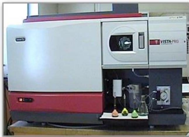
Slika 11. ICP-OES uređaj za određivanje koncentracije metala
