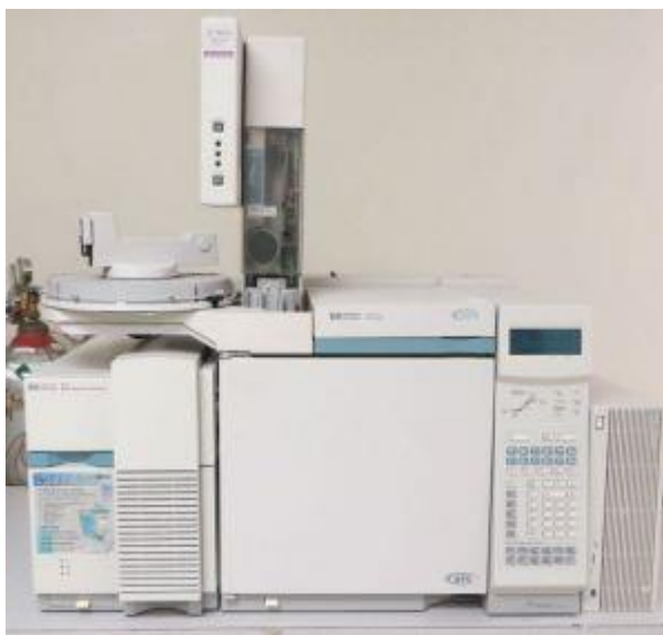
Slika 14. Gasni hromatograf sa masenim detektorom, PTV injektorom i data stanicom, model HP 6890 GC, HP 5973
