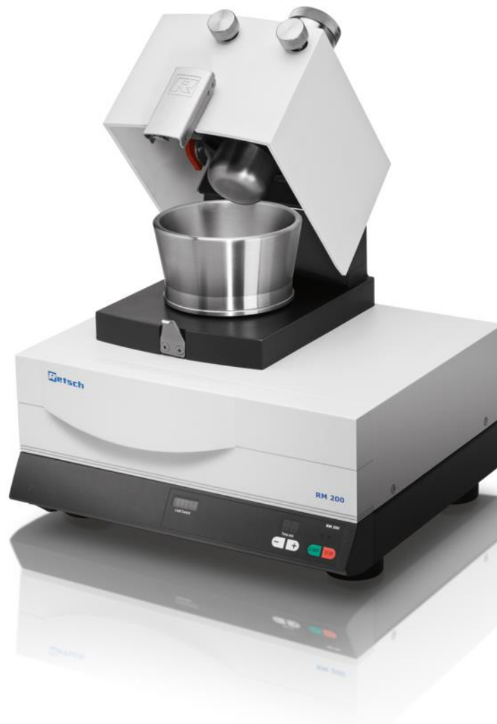
Slika 9. Uređaj za usitnjavanje uzoraka sedimenata MILL RM 200, Retsch
