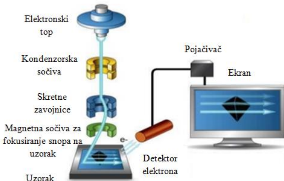
Slika 5.15. Šematski prikaz osnovnih dijelova skanirajućeg elektronskog mikroskopa. Prilagođeno iz [112].
