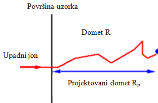
Slika 3.2. Šematski prikaz putanje upadnog jona: prikaz ukupnog dometa R i projektovanog dometa R_p .
