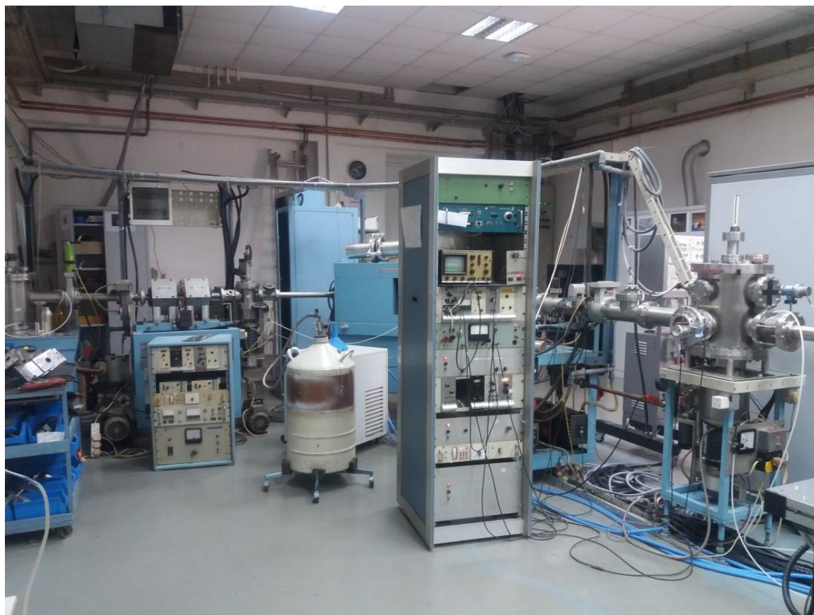
Slika 5.2. Izgled jonskog implantera (akceleratorско postrojenje u Laboratoriji za atomsku fiziku INN „VINČA”).
