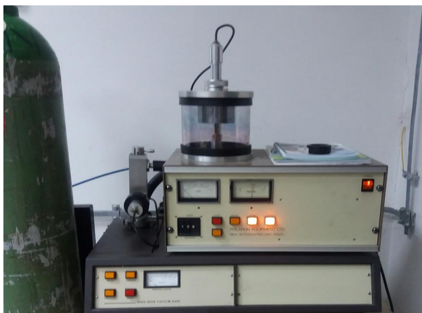
Slika 5.8. Uređaj za uklanjanje PS monosloja nagrizanjem O 2 plazmom.
