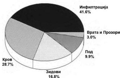
Слика 2.5. Губици енергије кроз термички омотач објекта 129
