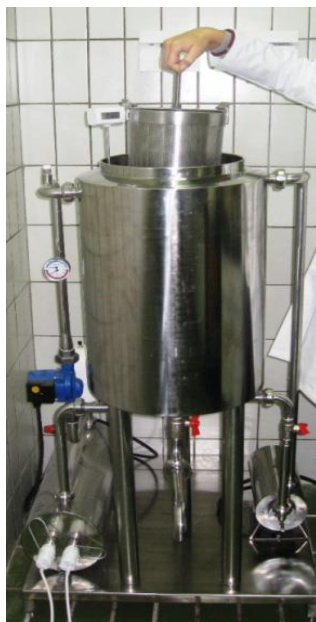
Slika 3.2 Izgled uređaja za osmotsku dehidraciju
