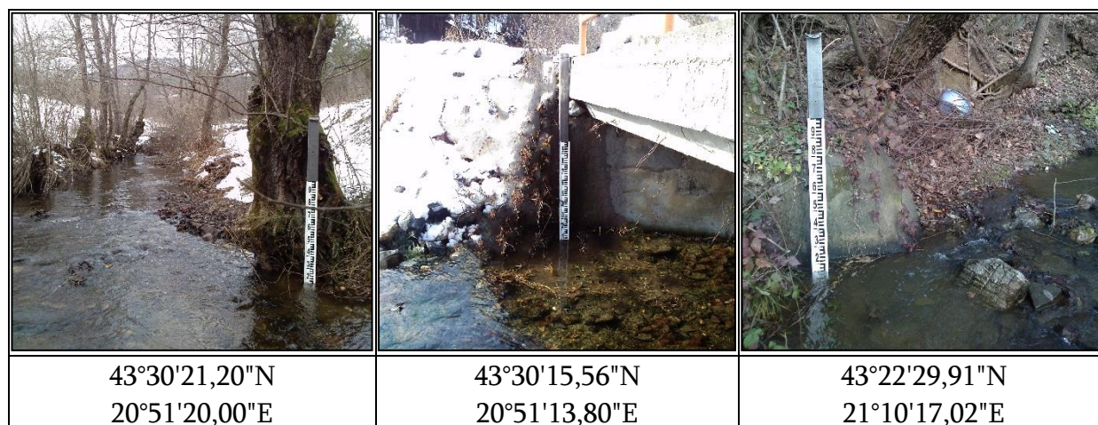
Слика 12 – Водомерне летве на одговарајућим профилима
