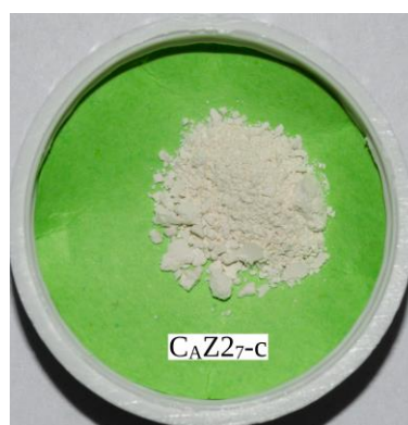
Слика 4.40 Фотографија праха добијеног преципитацијом цинк феритних честица на АРТЕС-функционализована силика језгра у присуству цитратних јона, \text{pH} = 7 и \text{MO} (силика/ \text{ZnFe}_2\text{O}_4 ) = 2
