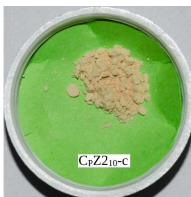
Слика 4.44 Фотографија праха добијеног преципитацијом цинк феритних честица на PDDA-функционализована силика језгра на pH = 10
