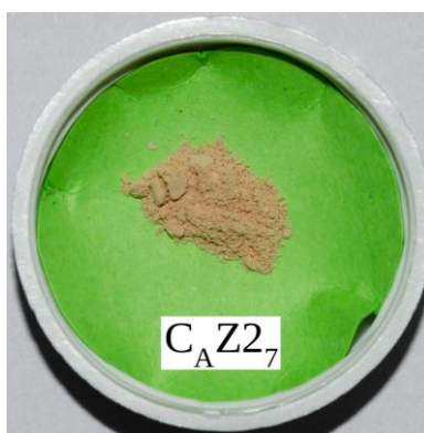
Слика 4.37 Фотографија праха добијеног преципитацијом феритних честица у присуству АРТЕS-функционализованих силика језгара честица на \text{pH} = 7 (узорак C_A Z27 )
