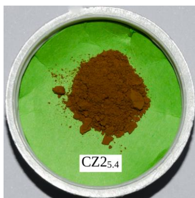
Слика 4.33 Фотографија праха добијеног преципитацијом феритних честица на нефункционализована силика језгра при \text{pH} = 5,4 и силика/ферит масеном односу од 2
