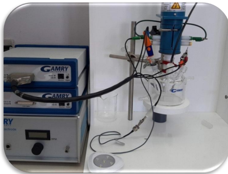
Slika 10. Fotografija korišćene troelektrodne ćelije za elektrohemijiska ispitivanja
